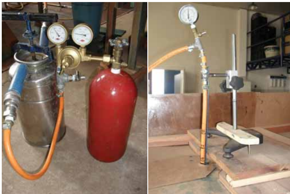
Figura 8. Sistema utilizado para as aplicações em túnel de vento. À esquerda reservatório de calda e cilindro de CO 2 (em vermelho), à direita local de posicionamento da ponta de pulverização e suporte tipo tripé.
