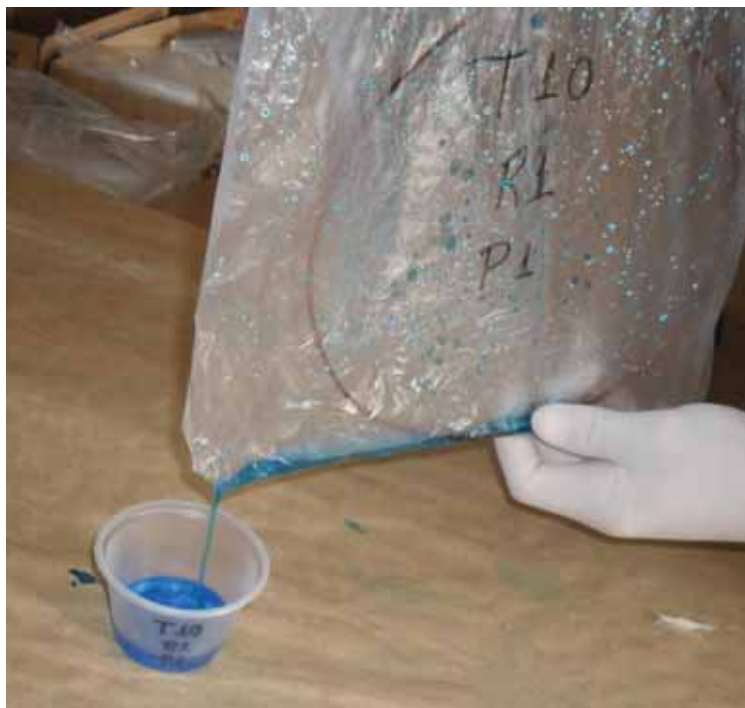
Figura 12. Lavagem dos fios coletores, detalhe para saco e recipiente plásticos identificados.
