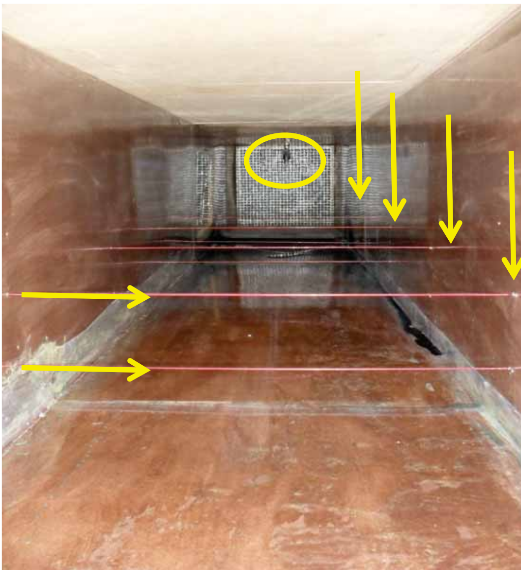
Figura 10. Imagem demonstrando a disposição dos fios coletores, alturas e distâncias na seção de testes, em relação ao piso do túnel e a ponta de pulverização, respectivamente.
