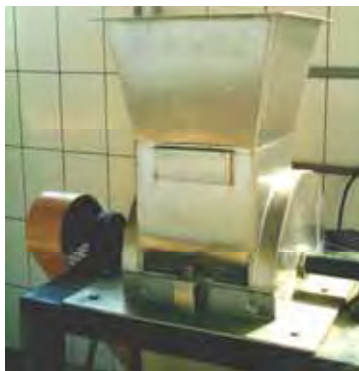
Figura 8. Desintegrador para raízes tipo sevadeira em aço inox para produção de polpas.
