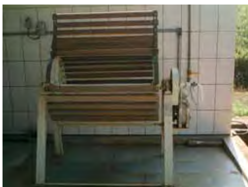
Figura 7. Lavador-Descascador de raízes de mandioca com acionamento elétrico.
