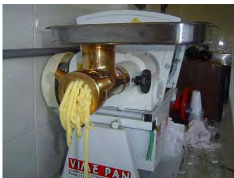
Figura 11. Moedor industrial, usado na mistura da massa e dos tratamentos.
