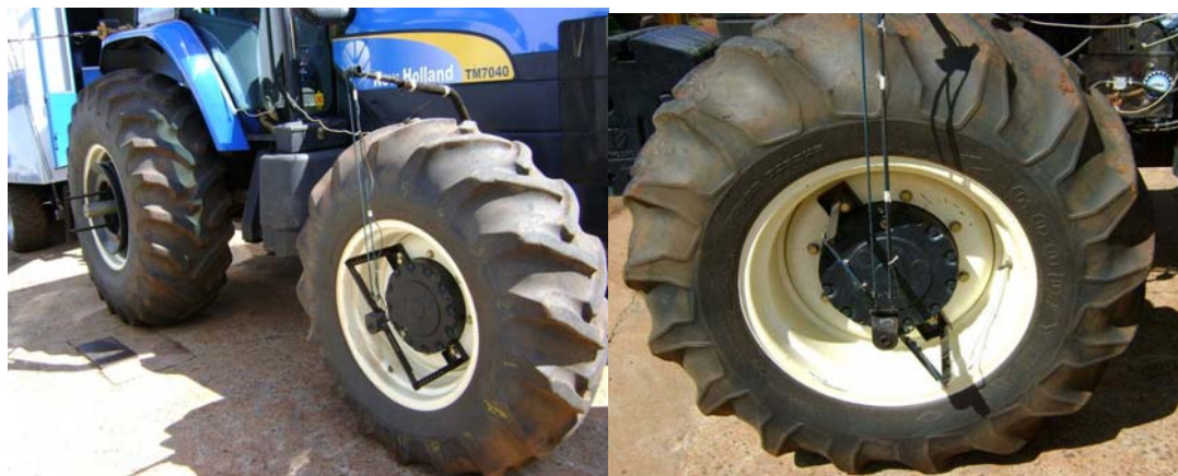
Figura 6 – Geradores de pulsos instalados no trator para determinar a patinação das rodas.
