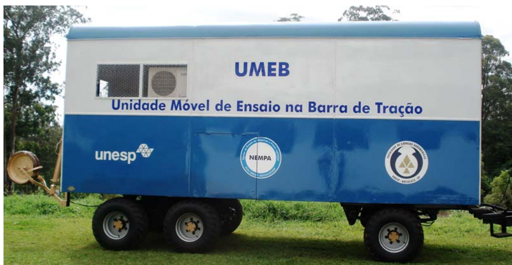
Figura 4 – Unidade móvel de ensaio na barra de tração – UMEB.
