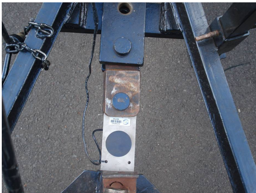
Figura 5 – Célula de carga marca SODMEX, modelo N400.
