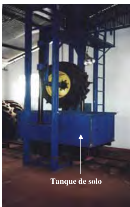
Figura 12. Unidade hidráulica de prensagem de pneus e tanque de solo. Vista geral.
