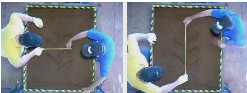
Figura 14. Determinação das medidas das diagonais da área de contato pneu/solo.
