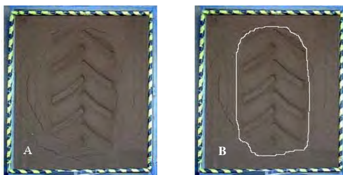
Figura 15. Foto da área de contato entre o pneu e solo e do quadro de madeira (A); Imagem da uma área de contato sendo processada no AUTOCAD® (B).
