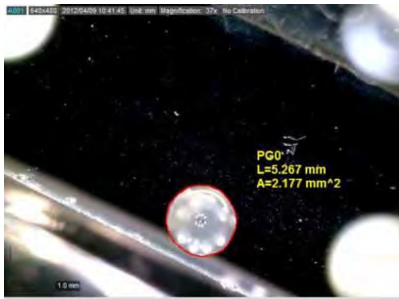
Figura 5. Imagem gerada pela câmera posicionada perpendicularmente e detalhe das medições realizadas.
