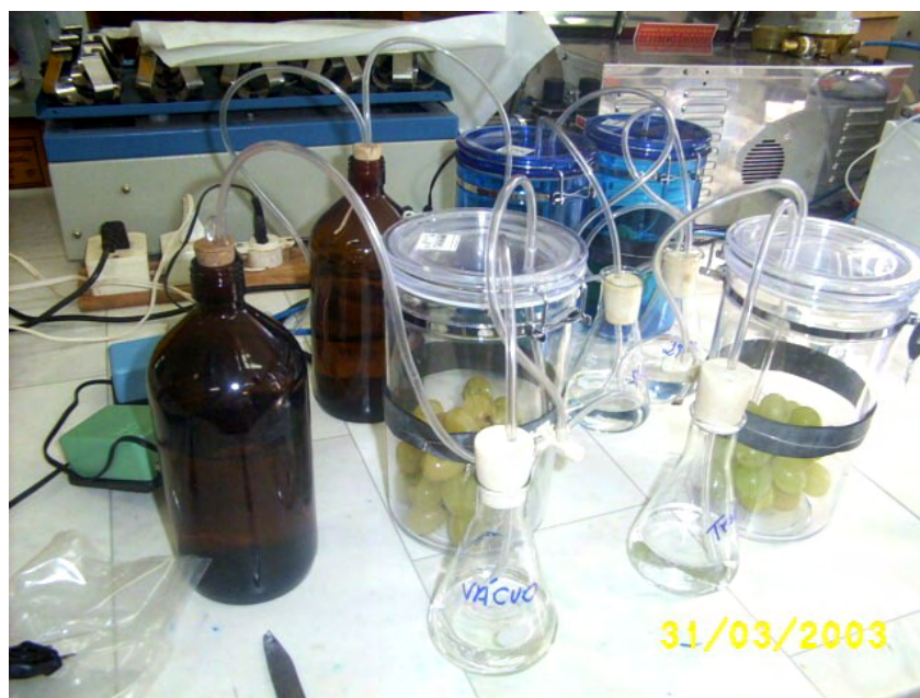
Figura 8. Equipamento utilizado para medir a respiração das uvas ‘Itália.
