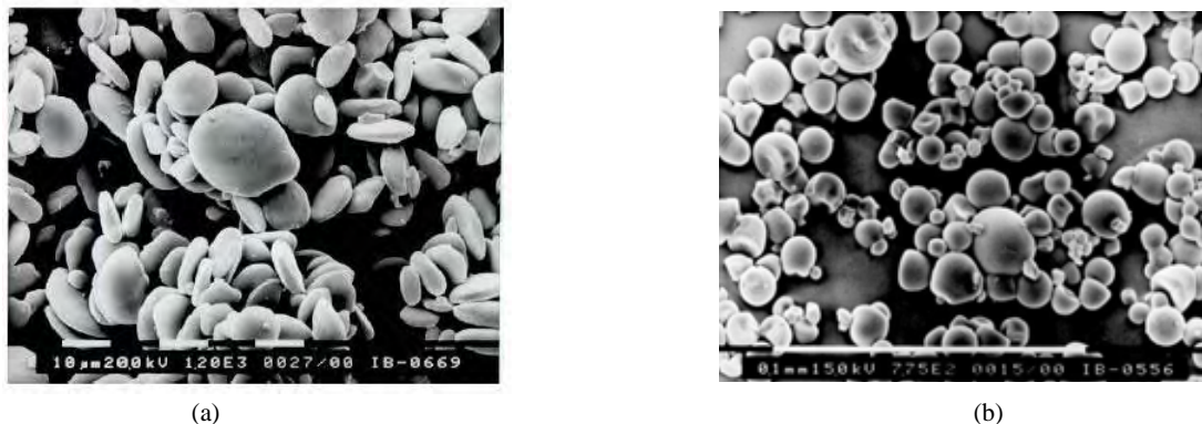
Figura 3- Microscopia de grânulos de amido de gengibre (a) e mandioca (b) observados em microscópio eletrônico de varredura (aumento 1440x). Fonte: Leonel et al. (2005).
