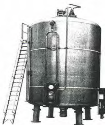
Figura 8- Acetificador Frings em aço inoxidável. Fonte: (TAKEMOTO, 2000).
