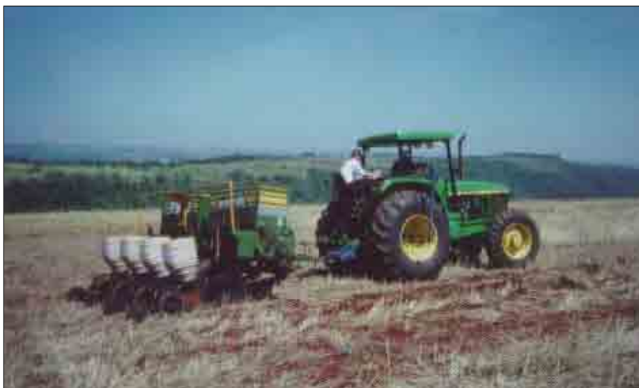
Figura 5. Conjunto trator-semeadora-adubadora PST 2 .
