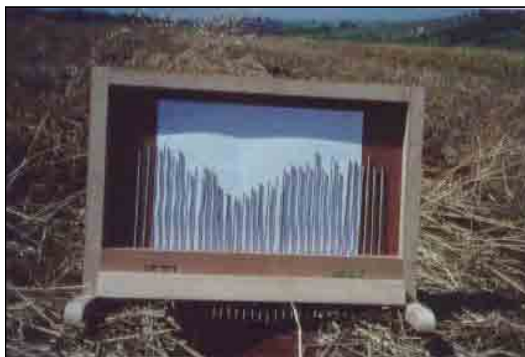
Figura 6. Perfilômetro utilizado para avaliar a área de solo mobilizado e a profundidade do sulco na linha de semeadura.
