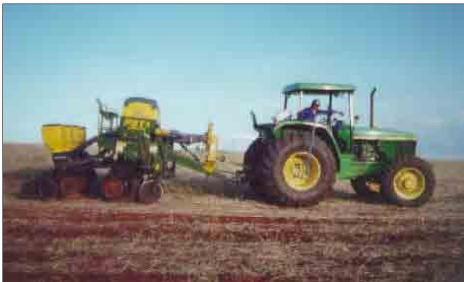
Figura 4. Conjunto trator-semeadora-adubadora PST 3 -Suprema.
