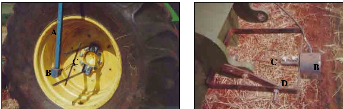
Figura 8. Detalhe da instalação do gerador de impulso no rodado do trator (esquerda) e no eixo da semeadora-adubadora (direita). (A - haste vertical, B - gerador de impulso, C – conexão do gerador ao eixo da roda, D – suporte para fixação do gerador de impulso).
