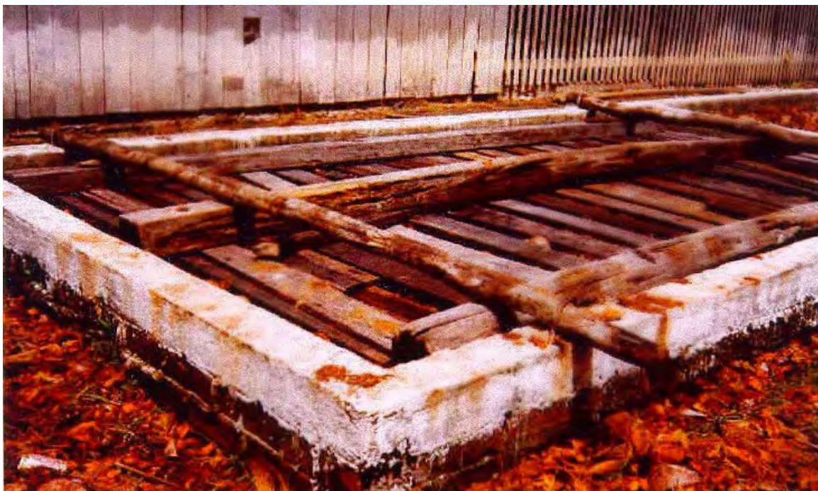
Figura 4. Vista do tanque com as cascas de coco já tampado por madeiras e, em seguida, adiciona-se água até o preenchimento total do tanque.
