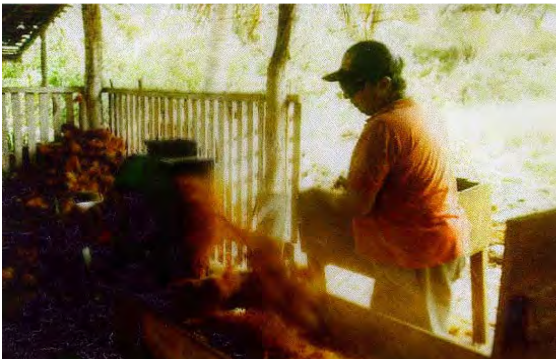
Figura 6. Vista da casca de coco sendo desfibrada por meio de uma forrageira adaptada.
