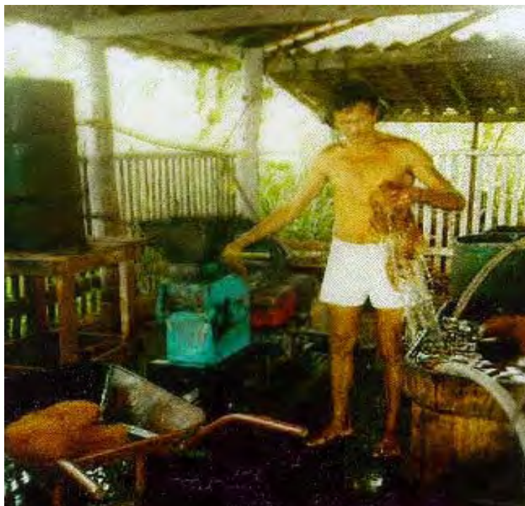
Figura 8. Fibras de coco sendo retiradas da caixa d'água e passando novamente pela forrageira adaptada para melhor desfibramento.
