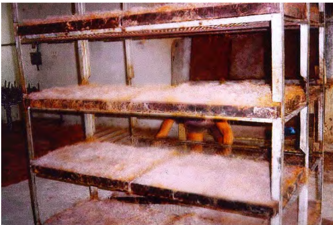
Figura 5. Vista das mantas de fibra de coco com látex dispostas em bandejas sendo levadas para a estufa.
