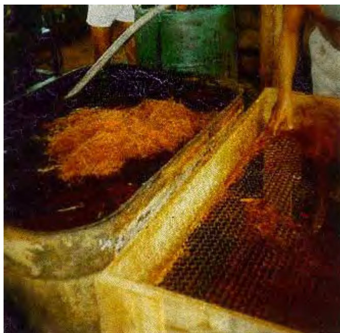
Figura 7. Casca de coco desfibrada sendo mergulhada em uma caixa d'água.
