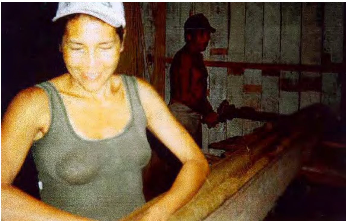
Figura 11. Fibra de coco sendo encordoada para a confecção dos rolos de corda e para facilitar o seu transporte.
