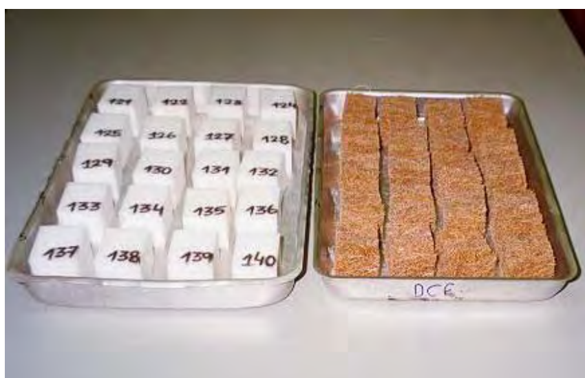
Figura 7. Bandeja para envelhecimento acelerado das amostras sem umidade.
