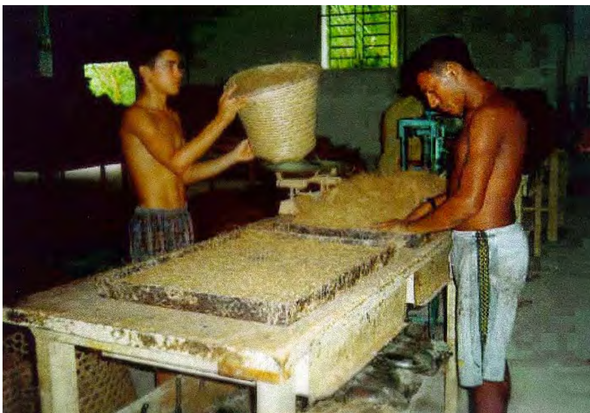
Figura 3. Pesagem e distribuição manual das fibras de coco sobre a bandeja para a confecção das mantas de fibra de coco.
