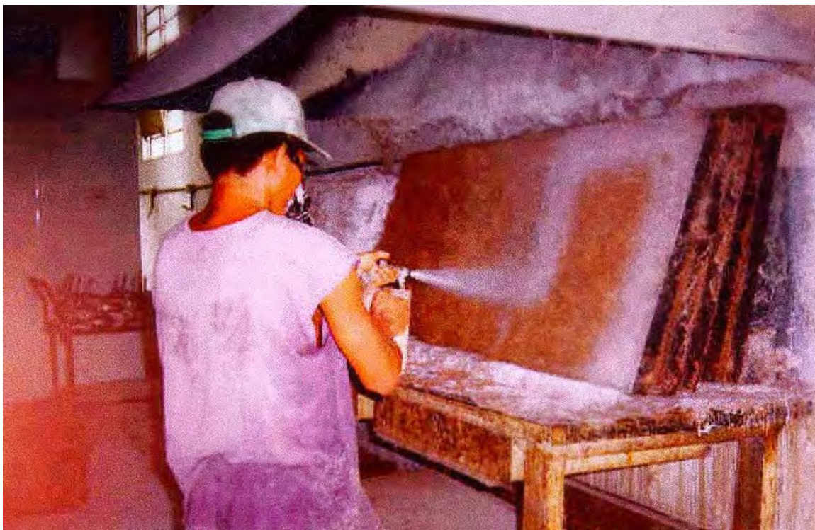
Figura 4. Aplicação de látex sobre as fibras de coco dispostas nas bandejas para a confecção das mantas.
