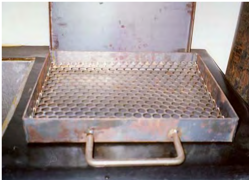
Figura 6. Bandeja para envelhecimento acelerado das amostras com umidade.
