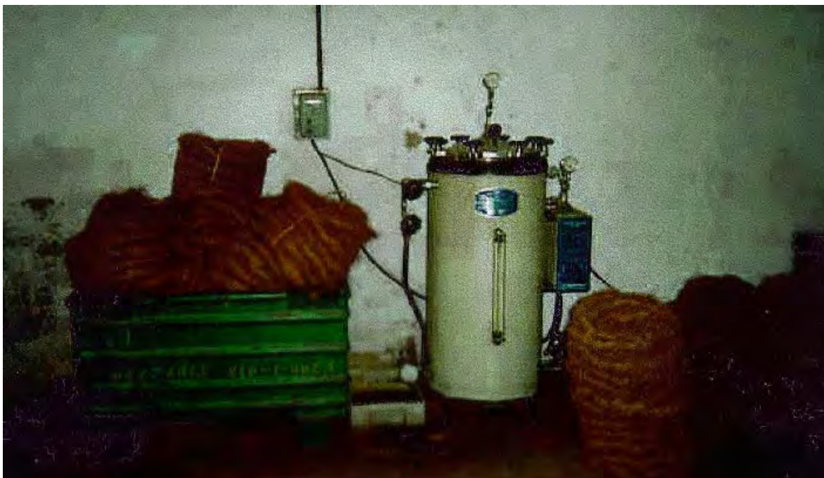
Figura 1. Fibra de coco encordoada é colocada no interior de uma autoclave para a memorização da corda.
