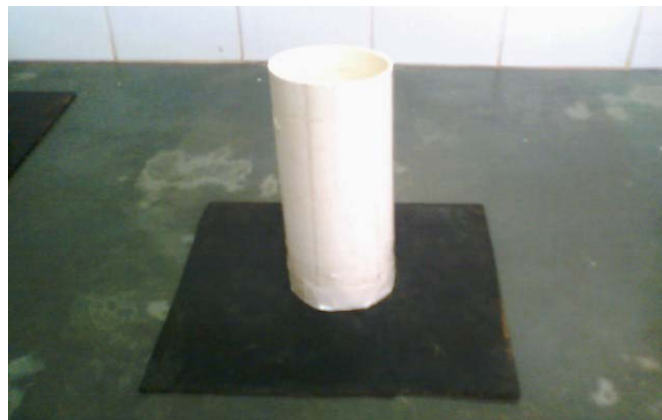
Figura 10 – Tubo em PVC com 70mm de diâmetro e 200mm de altura, utilizado para armazenagem de solo e avaliação do teor de água deste solo pela técnica TDR.
