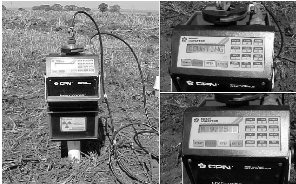
Figura 8 – Sonda de Nêutrons marca CPN, modelo 503 DR Hidroprobe (50 mCi Am-241/Be).(FERREIRA 2003).
