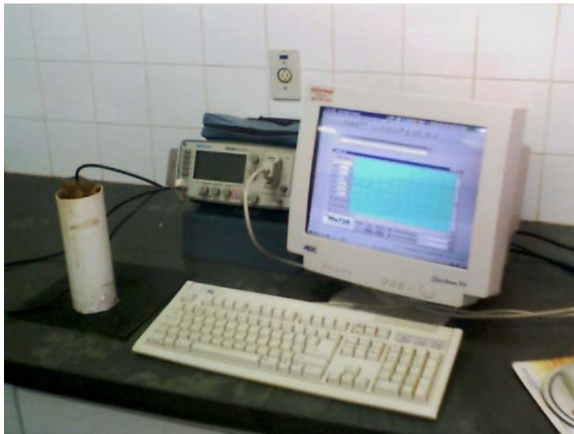
Figura 5 – Osciloscópio Tektronix, tipo TDR, modelo 1502B com a interface Tektronix, modelo SP 232 sonda com 3 hastes e computador.
