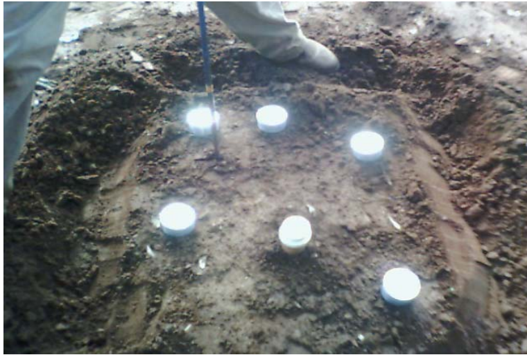
Figura 9 – Amostragem de solo ao redor do tubo-guia da sonda de nêutrons.
