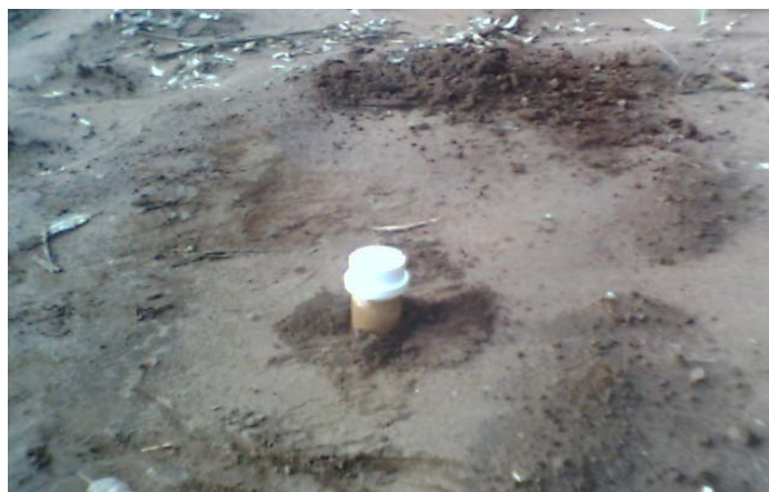
Figura 7 – Tubo-guia para sonda de nêutrons instalado.
