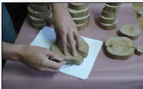
Figura 3. Contorno dos discos da base em uma folha de A4 de amostras da espécie de Eucalyptus sp.
