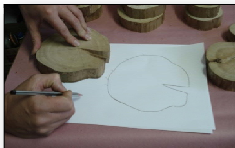
Figura 3. Contorno dos discos da base em uma folha de A4 de amostras da espécie de Eucalyptus sp.
