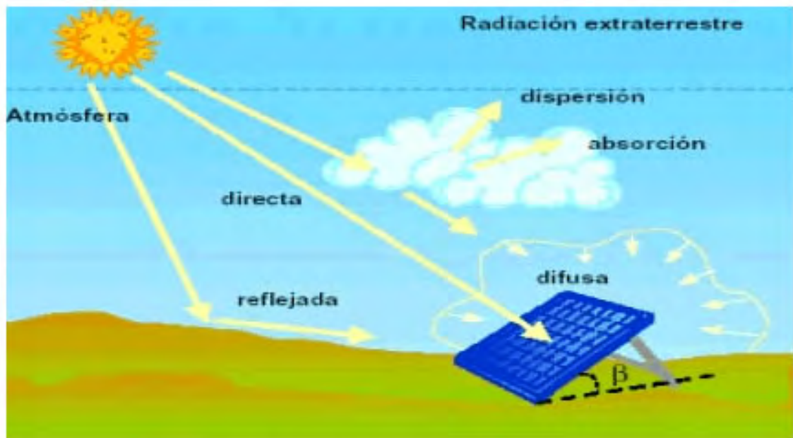
Figura 1- transformações da radiação solar.
