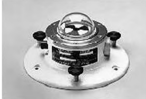
Figura 21 - Esquema de um piranômetro
