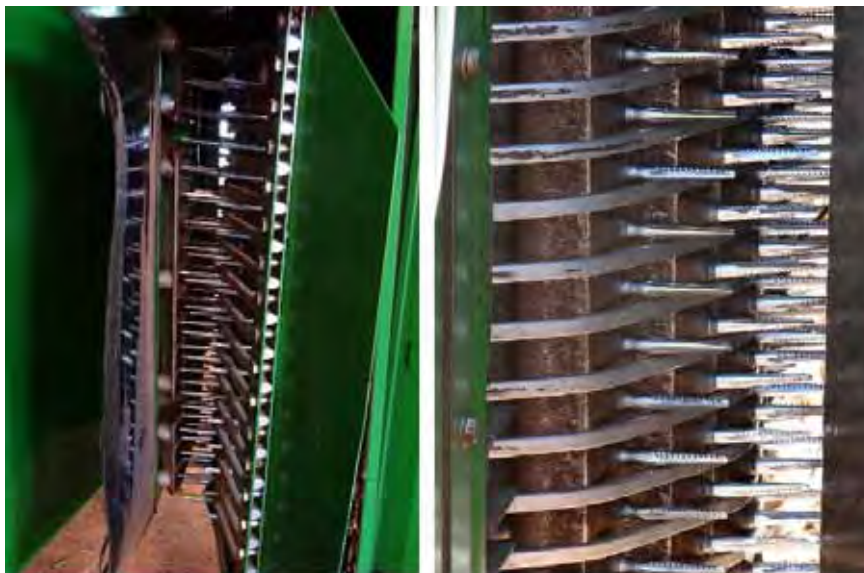
Figura 1. Fusos rotativos dos tambores de colheita de sistema picker . Foto: Francielle Morelli Ferreira (2012).
