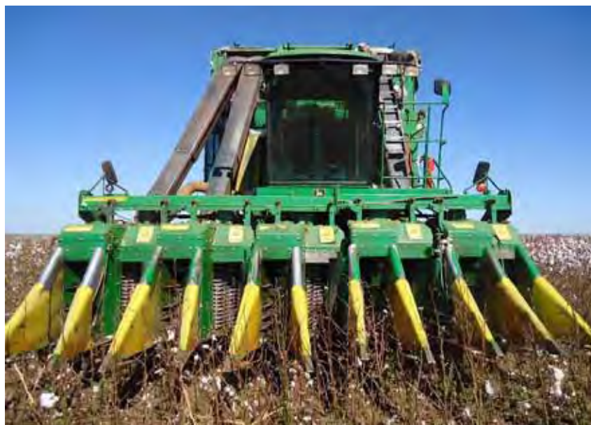
Figura 5. Colhedora John Deere com plataforma de colheita picker adaptada para colher algodão com espaçamento de 0,45 m, tendo como base o corte e o transporte das plantas de uma fileira para a fileira adjacente e assim proceder à extração dos capulhos. Foto: Francielle Morelli Ferreira (2012).
