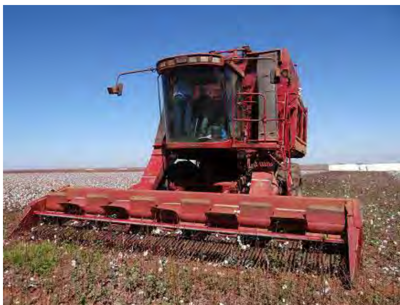
Figura 6. Colhedora com plataforma de sistema stripper para colheita de algodão adensado. Foto: Francielle Morelli Ferreira (2012).
