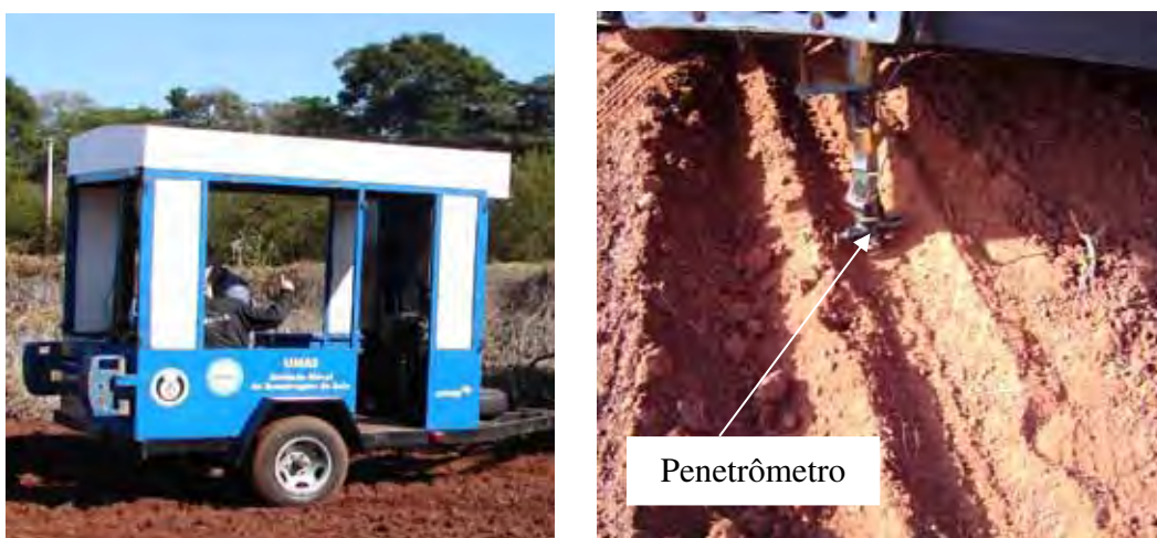
Figura 6: Vista geral da Unidade Móvel de Amostragem de Solo – UMAS, à esquerda e Penetrômetro Hidráulico Eletrônico operando, à direita.
