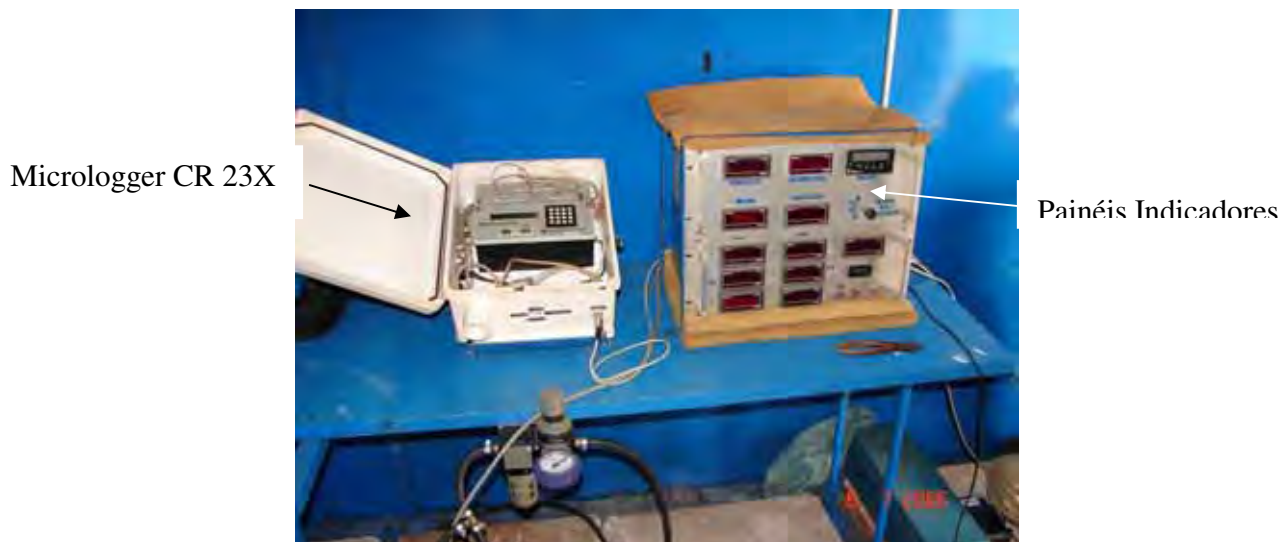
Figura 7: Sistema de monitoramento e coleta de dados, composto pelo Micrologger CR23X, e painéis com indicadores eletrônicos.
