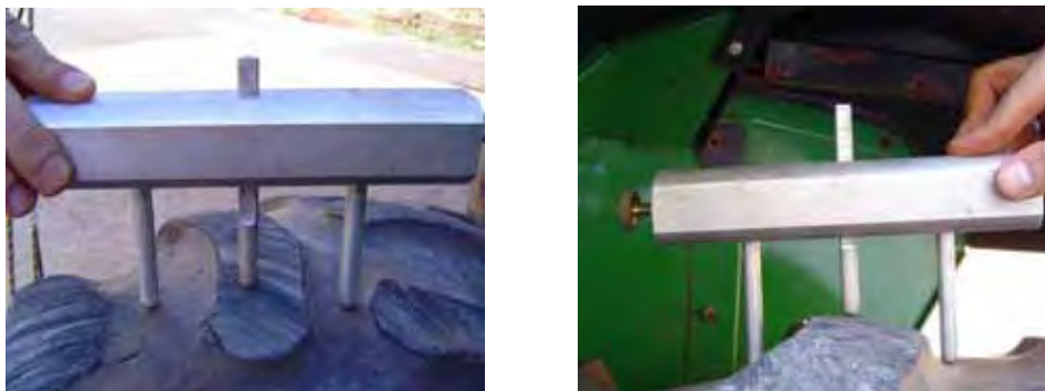
Figura 12 : Medição da altura das garras dos pneus dianteiro e traseiro desgastados
