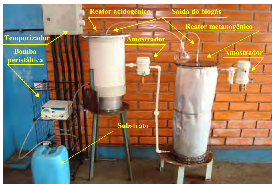
Figura 11: Reatores de digestão anaeróbia
