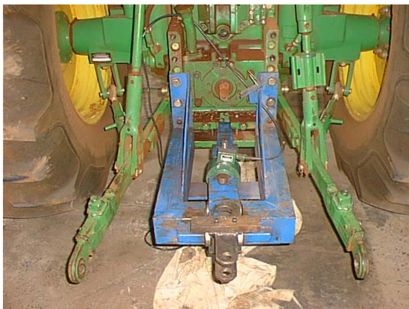
Figura 4. Célula de carga instalada no trator para medição da força de tração.
