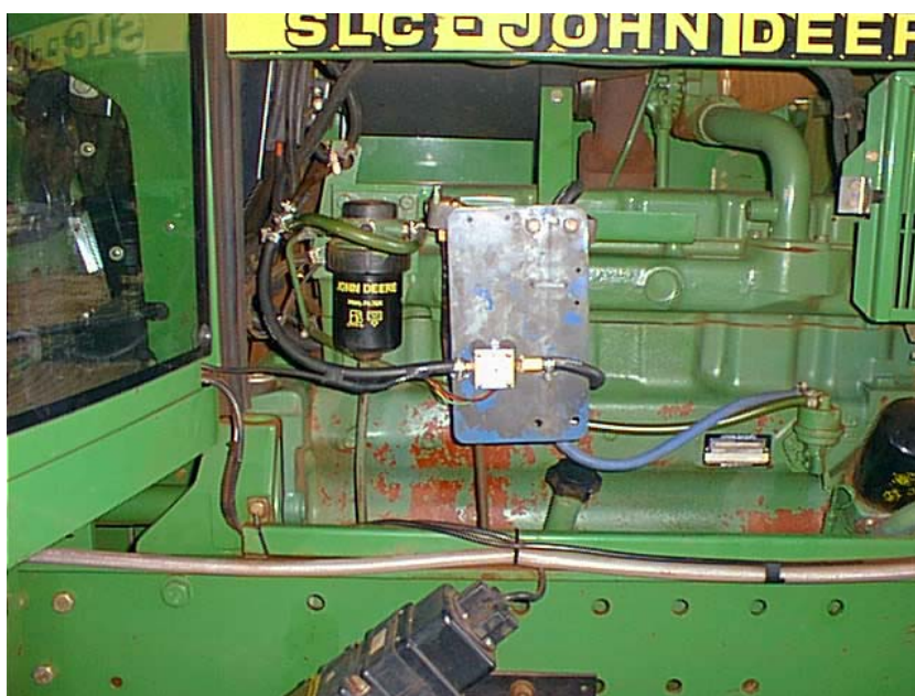
Figura 3. Fluxômetro instalado no trator para medição do consumo de combustível.
