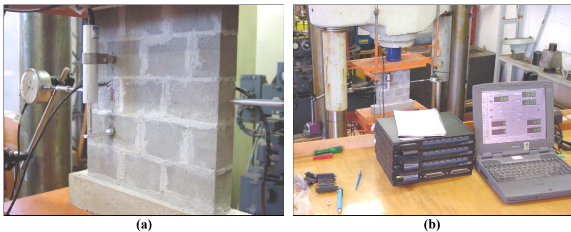
Figura 6.14 – (a) -Posicionamento de LVDT, relógios e extensômetros e (b) - Esquema de ensaio e sistema de aquisição de dados
