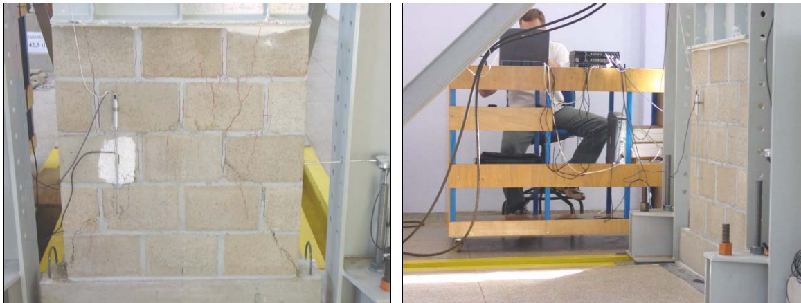
Figura 6.5 – Extensômetro, relógio, LVDT e sistema de aquisição de dados
