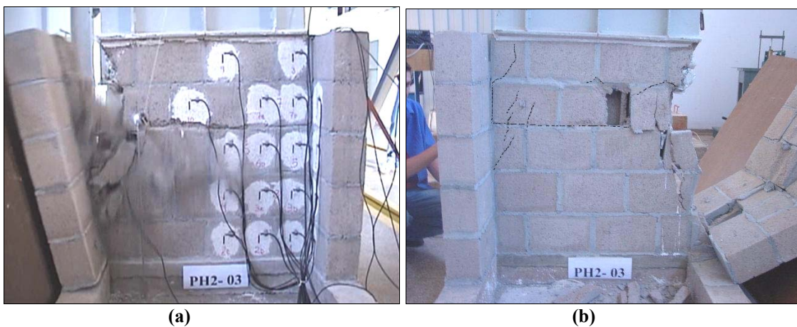
Figura 8.23 – (a) Instante da Ruptura e (b) Detalhe da forma de ruptura (PH2_02)
