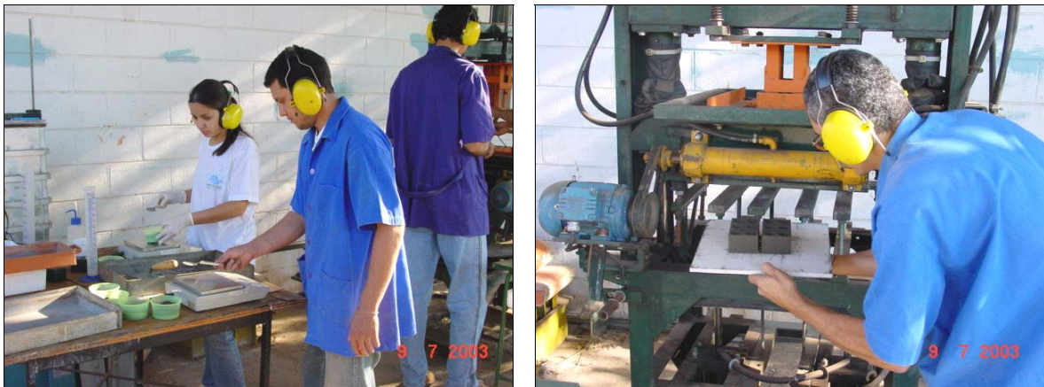
Figura 3.3 – Produção dos blocos na escala reduzida
