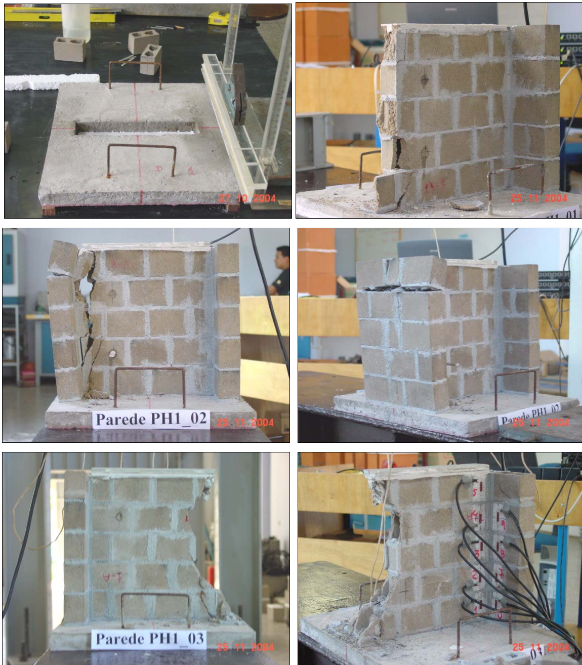
Figura 8.29 – Detalhe da forma de ruptura Paredes H tipo 1 – parede central não apoiada
