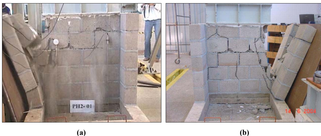
Figura 8.19 – (a) Instante da Ruptura e (b) Detalhe da forma de ruptura (PH2_01)
