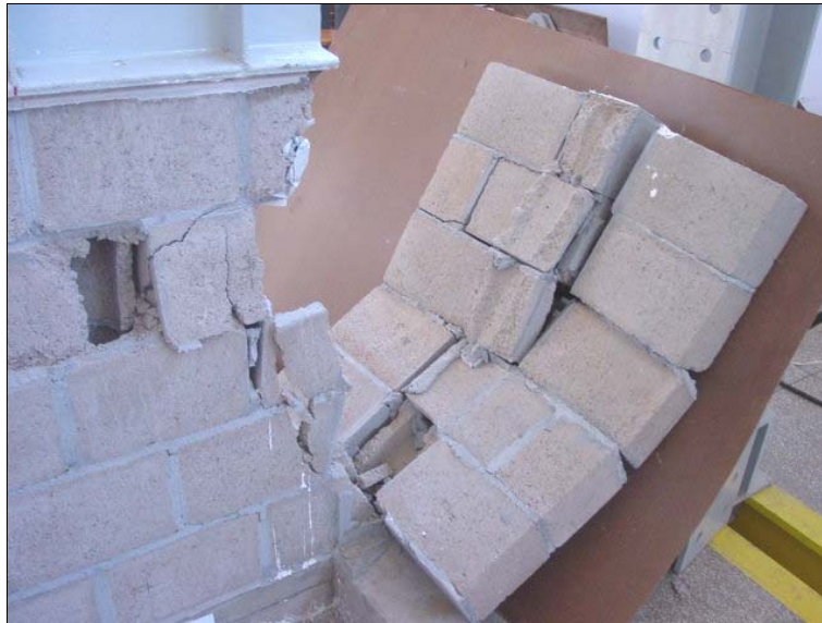
Figura 10.8 – Forma de ruptura - Blocos contrafiados cisalhados
