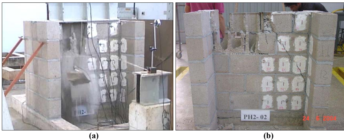
Figura 8.21 – (a) Instante da Ruptura e (b) Detalhe da forma de ruptura (PH2_02)
