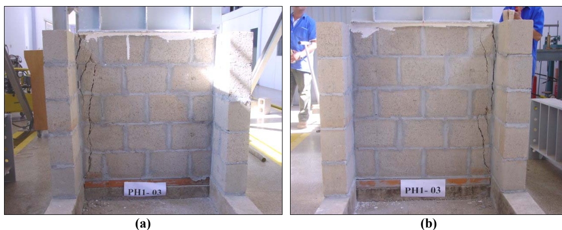
Figura 8.16 – (a) Instante da Ruptura e (b) Detalhe da forma de ruptura (PH1_03)
