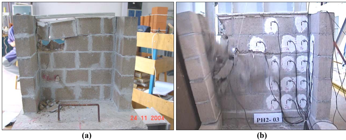
Figura 10.47 – Formas de ruptura – (a) escala reduzida (b) escala real
