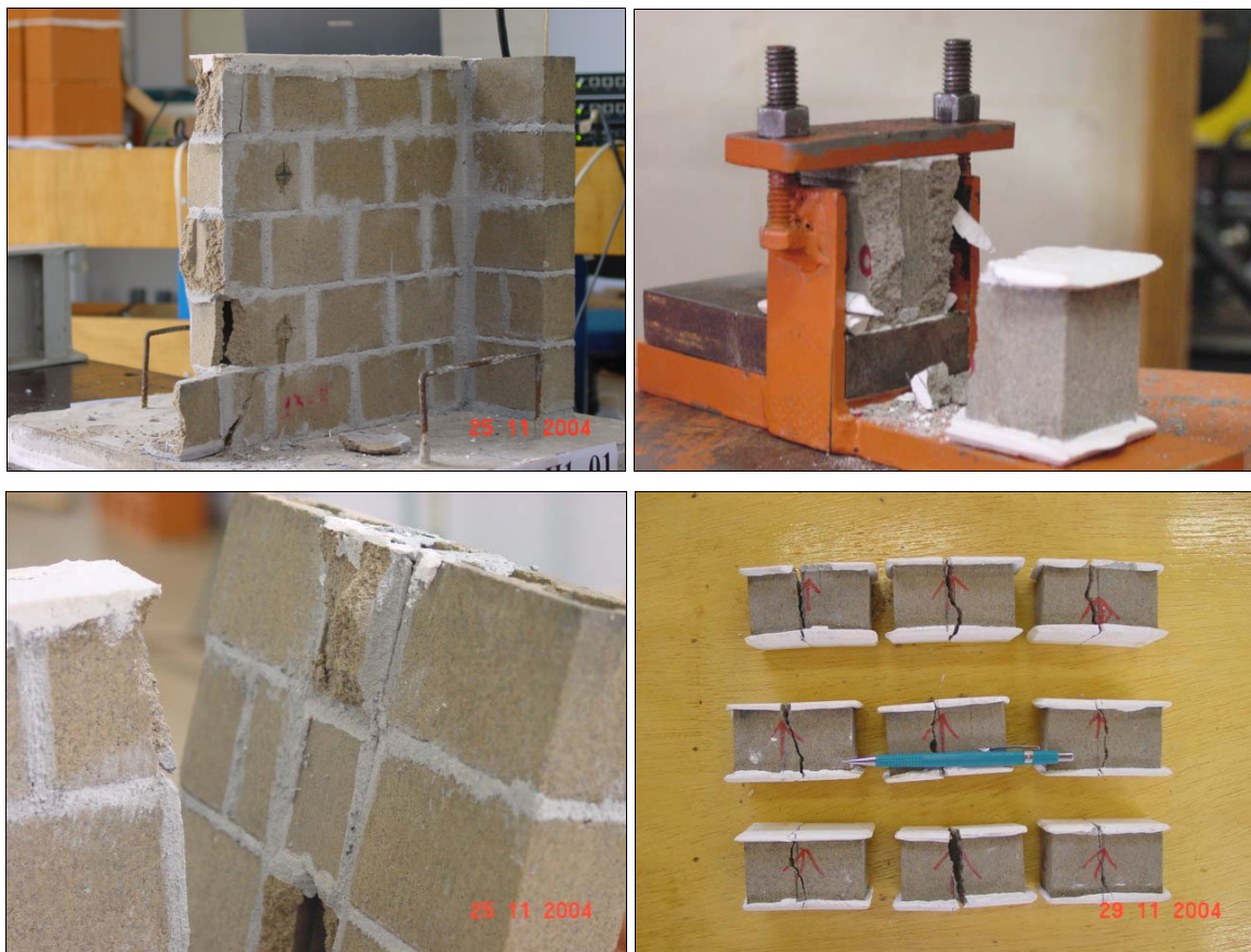
Figura 9.7 – Forma de ruptura das paredes H (1:4) e ensaio ao cisalhamento na unidade
