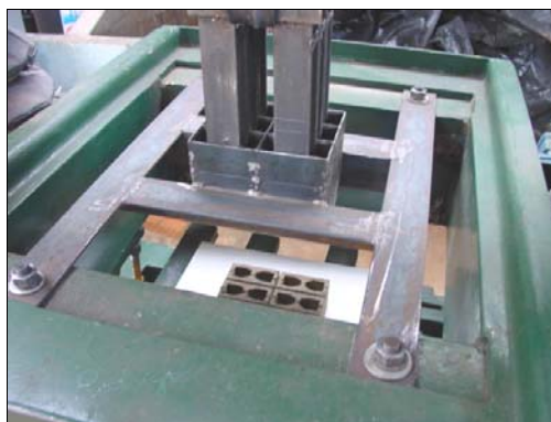
Figura 3.2 – Vibro-prensa e produção dos blocos na escala reduzida
