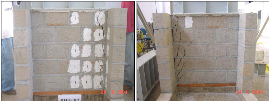
Figura 8.13 – Detalhes da forma de ruptura (PH1_02)
