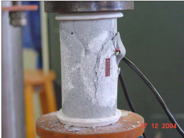
Figura 5.8 – Modo de ruptura da argamassa
