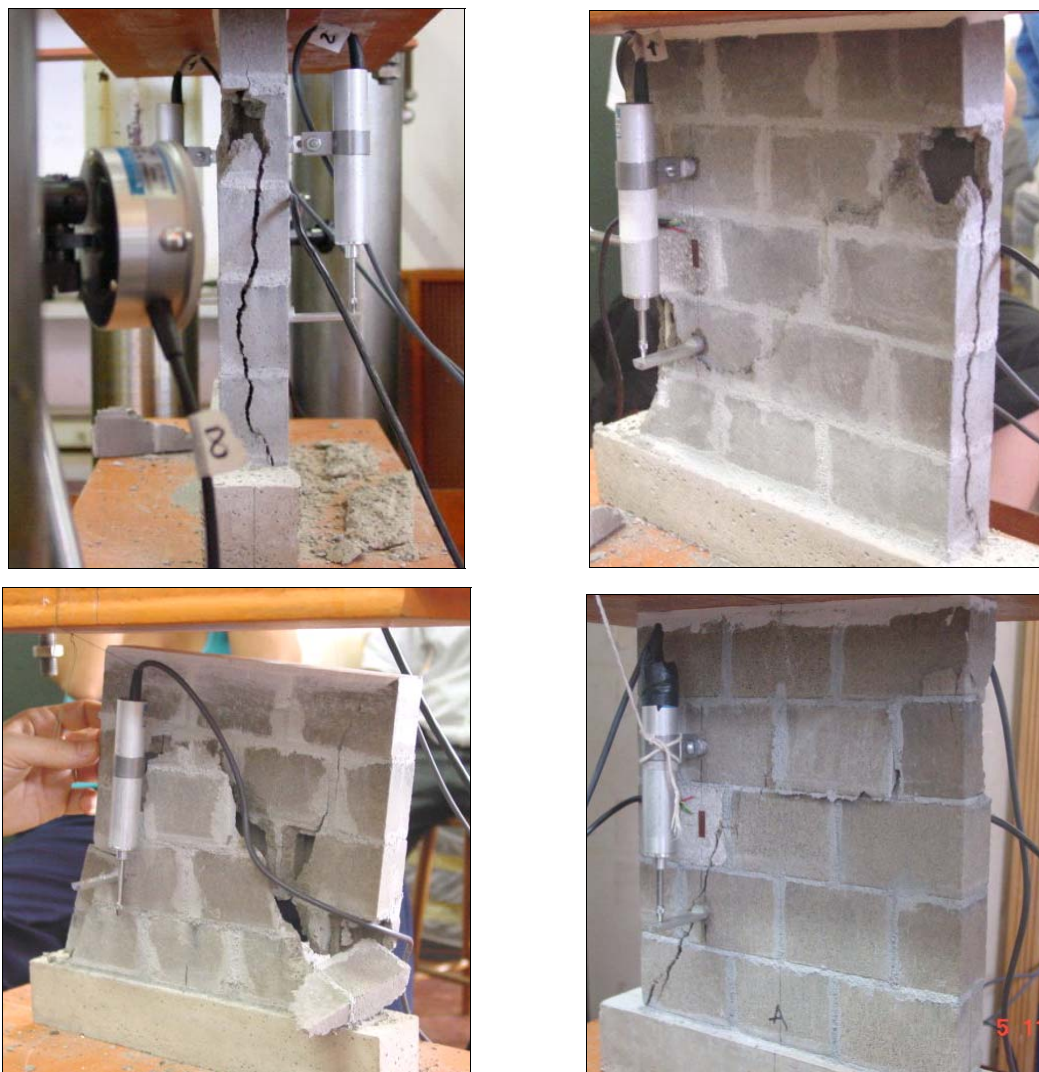
Figura 6.18 – Modo de ruptura das paredes
