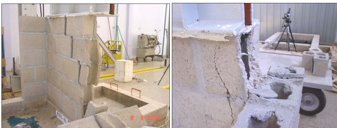
Figura 9.5 – Forma de ruptura dos blocos contrafiados das paredes H
