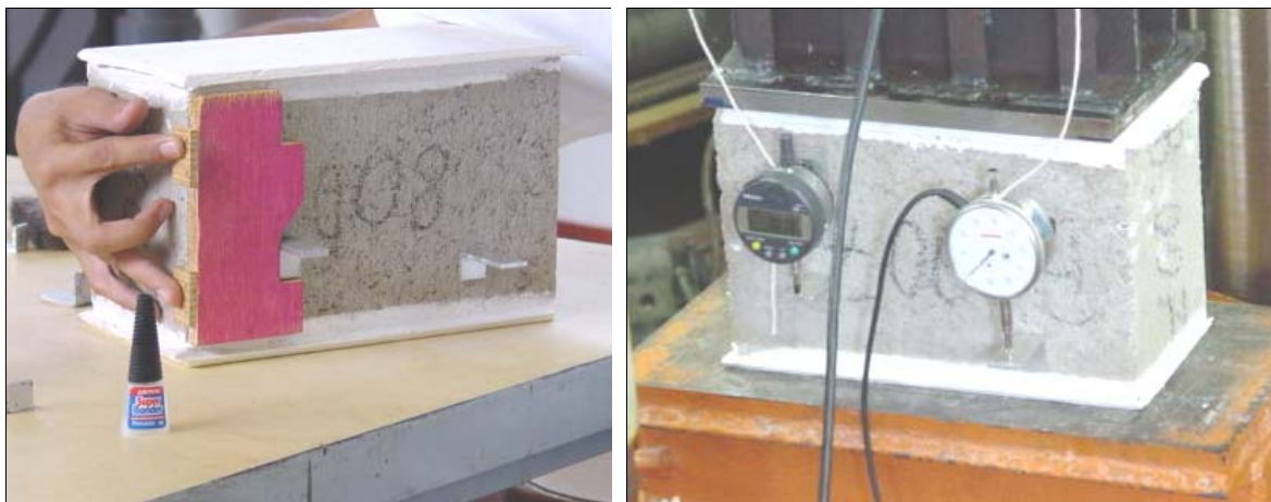
Figura 4.2 – Colagem das cantoneiras e fixação dos relógios de milésimo e centésimo
