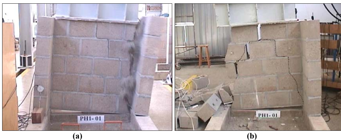
Figura 8.10 – (a) Instante da Ruptura e (b) Detalhe da forma de ruptura (PH1_01)
