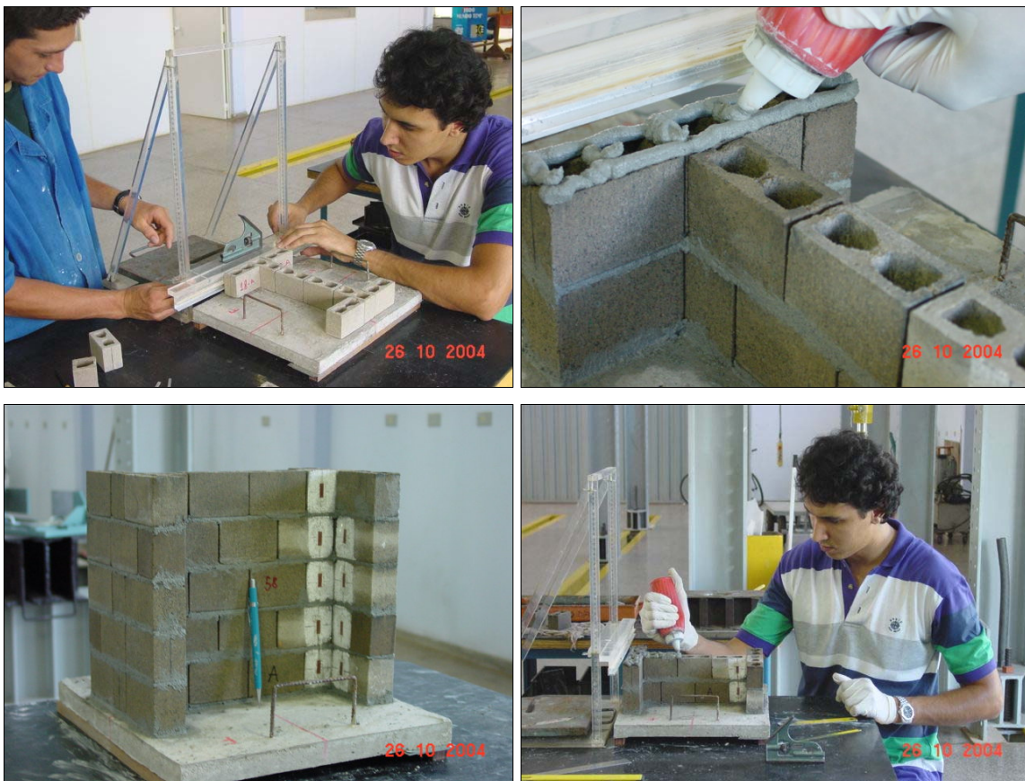
Figura 8.26 – Seqüência de montagem das paredes H na escala reduzida
