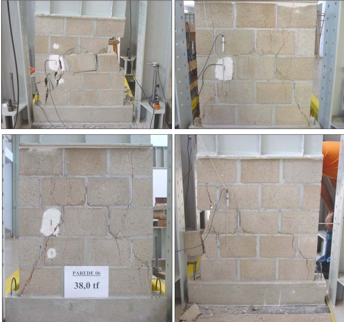
Figura 6.10 – Modo de ruptura das paredes
