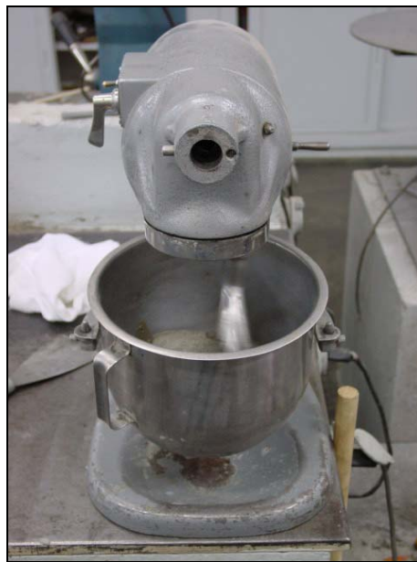
Figura 4. 10 – Argamassa sendo misturada com auxílio de argamassadeira elétrica
