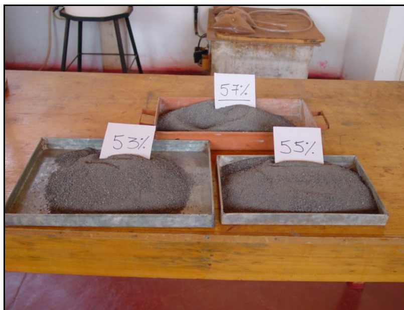
Figura 4.9 – Porções de areia e cimento a serem adicionadas na betoneira
