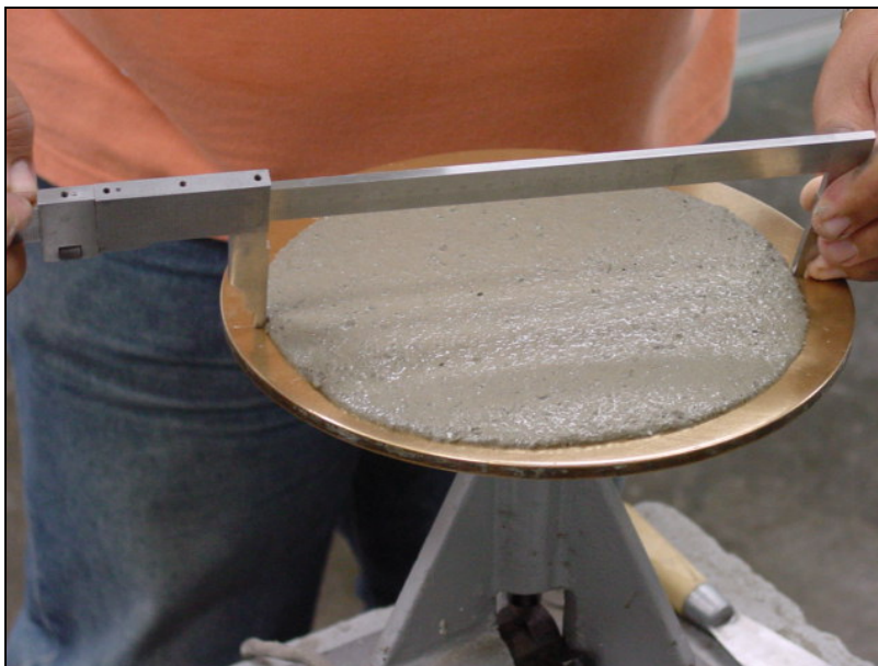
Figura 4. 12 –Medição do índice de consistência
