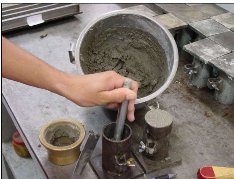
Figura 4. 13 – Moldagem dos corpos-de-prova
