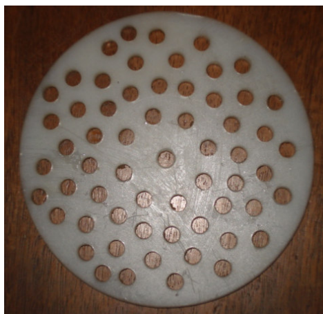
Figura 3.11: Placa de orifícios responsável pela homogeneização da velocidade do ar.
