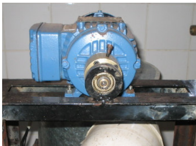
Figura 3.13: Sistema excêntrico e motor elétrico responsáveis pela vibração do leito de inertes.
