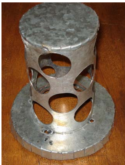
Figura 3.10: Copo distribuidor de fluxo de ar.
