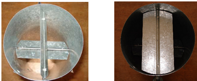
Figura 3.9: Sistema de aletas utilizado para homogeneização da velocidade do ar no leito com aletas em diferentes posições.
