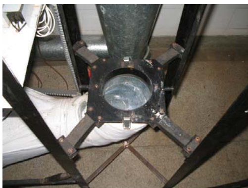
Figura 3.12: Base onde o leito de inertes é fixado por presilhas.
