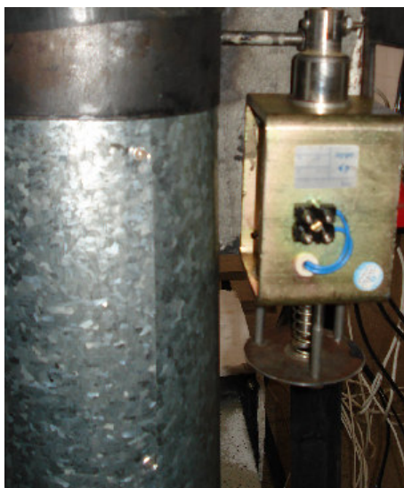
Figura 3.4: Solenóide responsável pelo efeito de pulsação.
