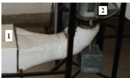
Figura 3.7: Curva de conexão entre a câmara de aquecimento e o leito de inertes. 1: Câmara de aquecimento de ar; 2: Leito de inertes.
