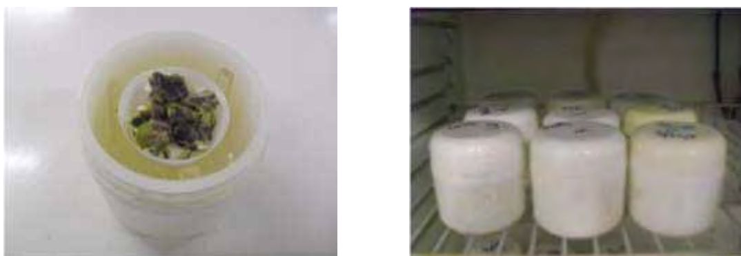
Figura 3.2 – Recipiente adotado para a obtenção das isotermas de sorção.
