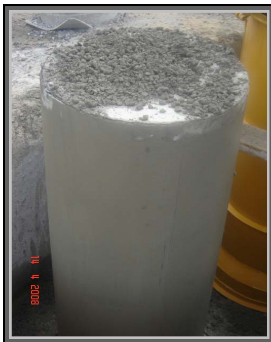
Figura 14: Fôrma Interna (vibradores para tubos \text{Ø}=600\text{mm} )
