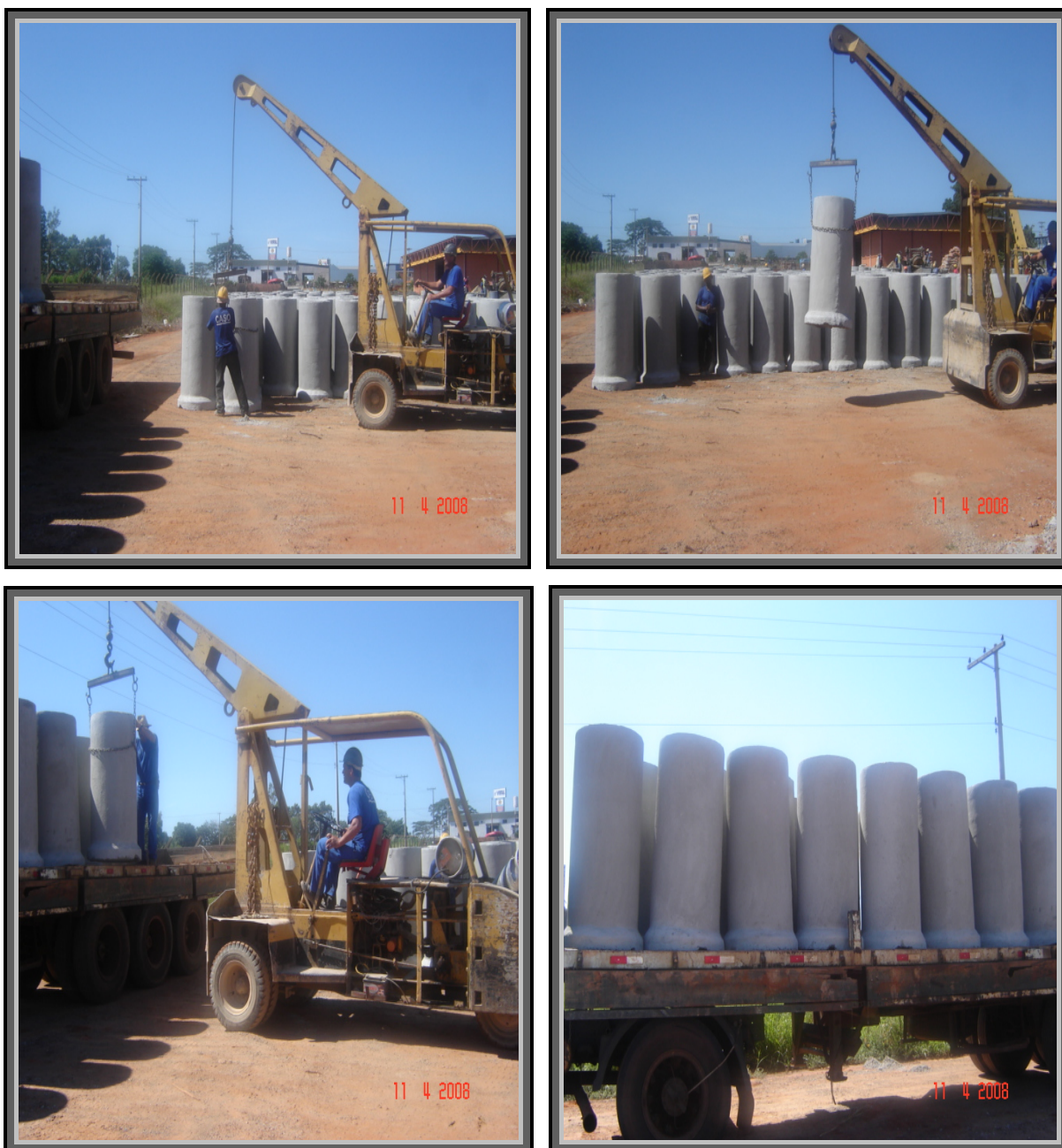
Figura 28: Transporte dos tubos de concreto da fábrica ao consumidor final Fonte: CASO CONSTRUTORA LTDA (2008)
