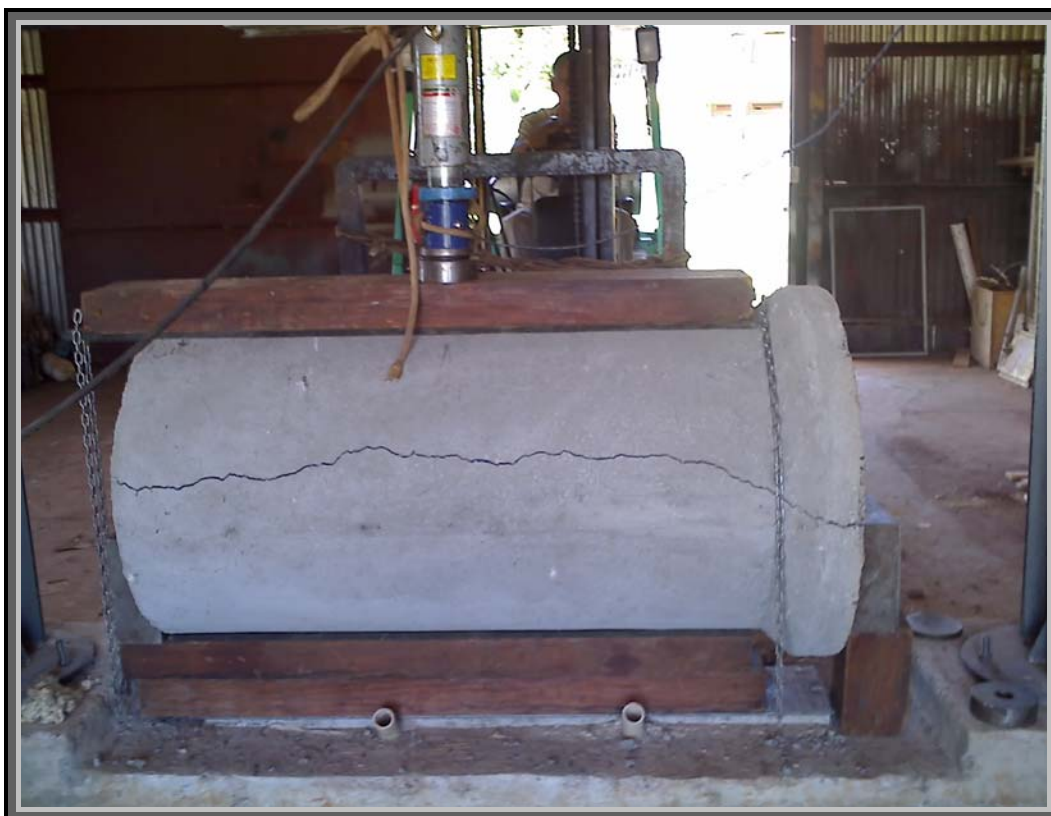
Figura 61: Tubo de concreto reforçado com fibra de aço após a ruptura
