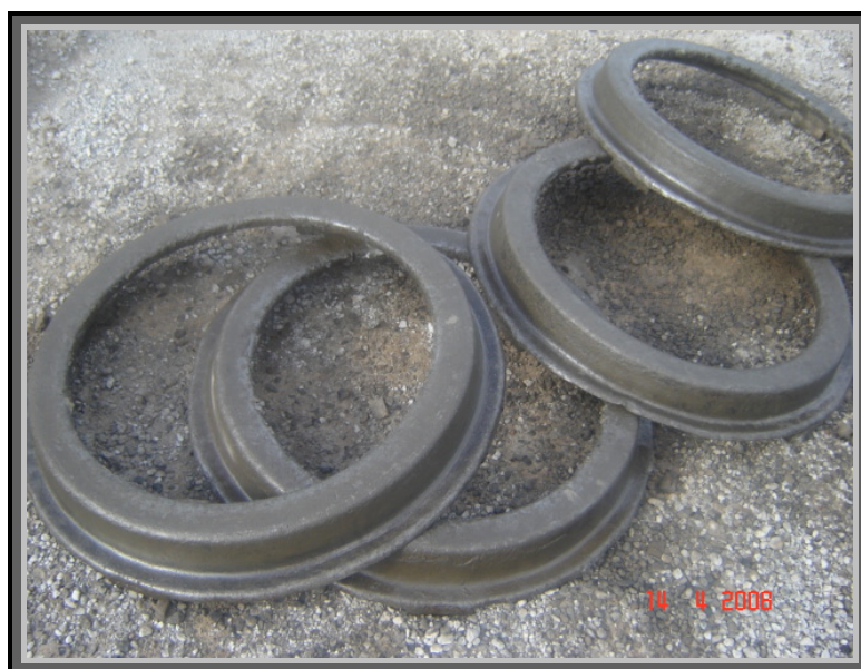
Figura 15: Anel - serve como base de sustentação para o tubo de concreto durante a cura
