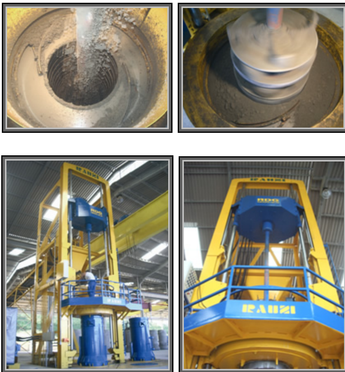
Figura 16: Produção de tubos de concreto utilizando prensa hidráulica automática
