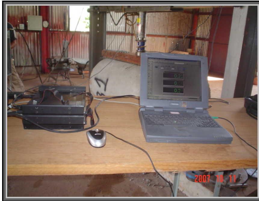
Figura 57: Sistema de aquisição de dados da marca Iotech (Daqbook 120) conectado a um micro-computador através do software DasyLab (versão 6.0)
