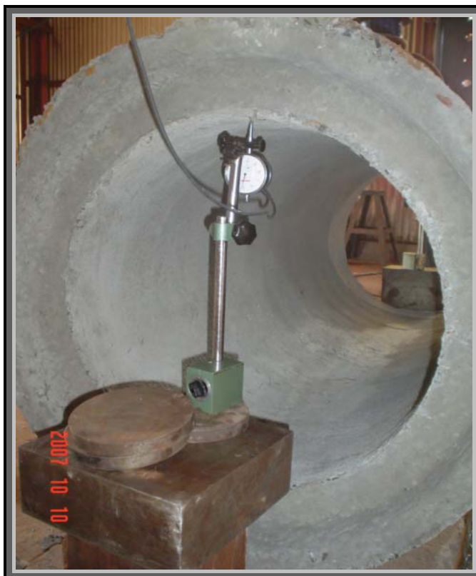
Figura 55: Relógio comparador colocado nas duas extremidades opostas do tubo para medir as deformações diametrais
