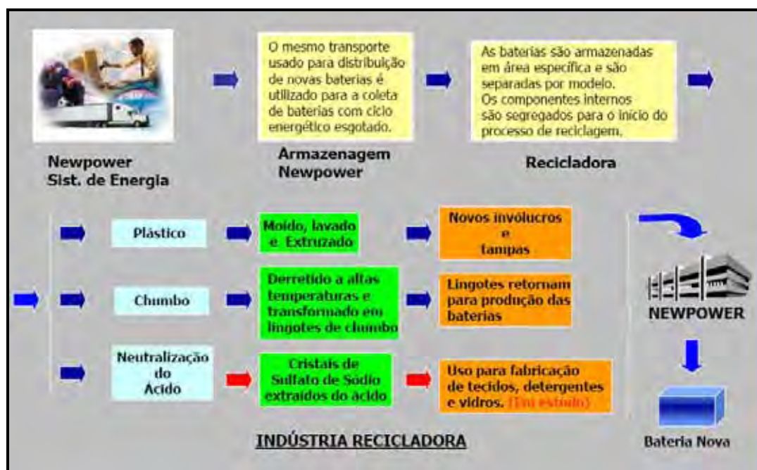
Figura 7: Fluxograma de reciclagem de bateria chumbo-ácido Fonte: <www.abinee.org.br>. Acesso em: 10 abr. 2007.
