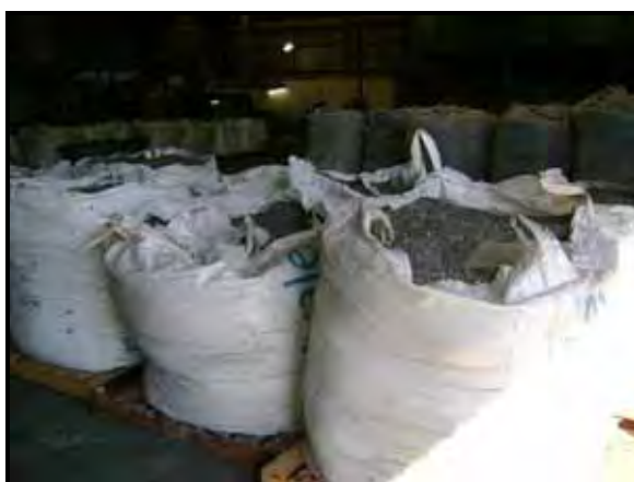
Figura 22: Chumbo triturado para envio ao reciclador Fonte: Crédito da autora.
