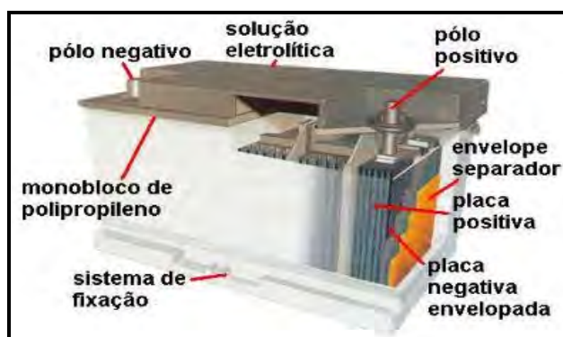
Figura 12: Componentes de uma bateria automotiva Fonte: < www.abinee.org.br >. Acesso em: 10 abr. 2007.
