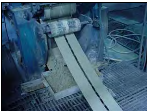
Figura 25: Saída da grade contínua do cabeçote de empastação Fonte: Empresa B (2008).
