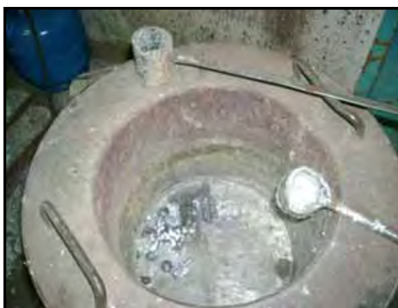
Figura 11: Cadinho manual para reciclagem do chumbo Fonte: Crédito da autora.
