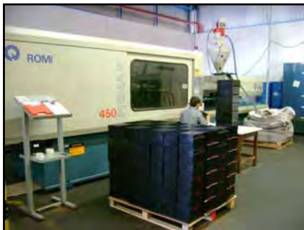
Figura 24: Máquina injetora e balet de caixas produzidas Fonte: Crédito da autora.
