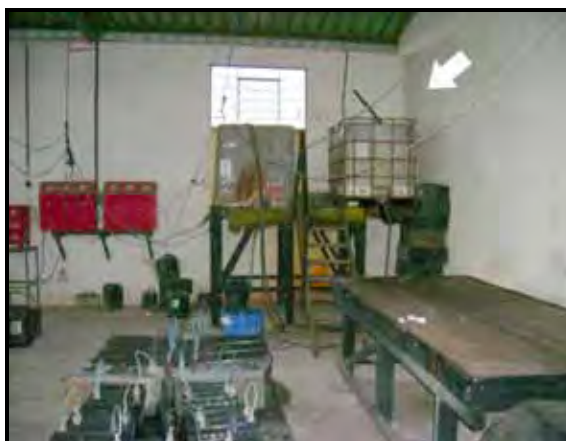
Figura 30: Vista parcial do galpão, armazenagem do ácido sulfúrico Fonte: Crédito da autora.
