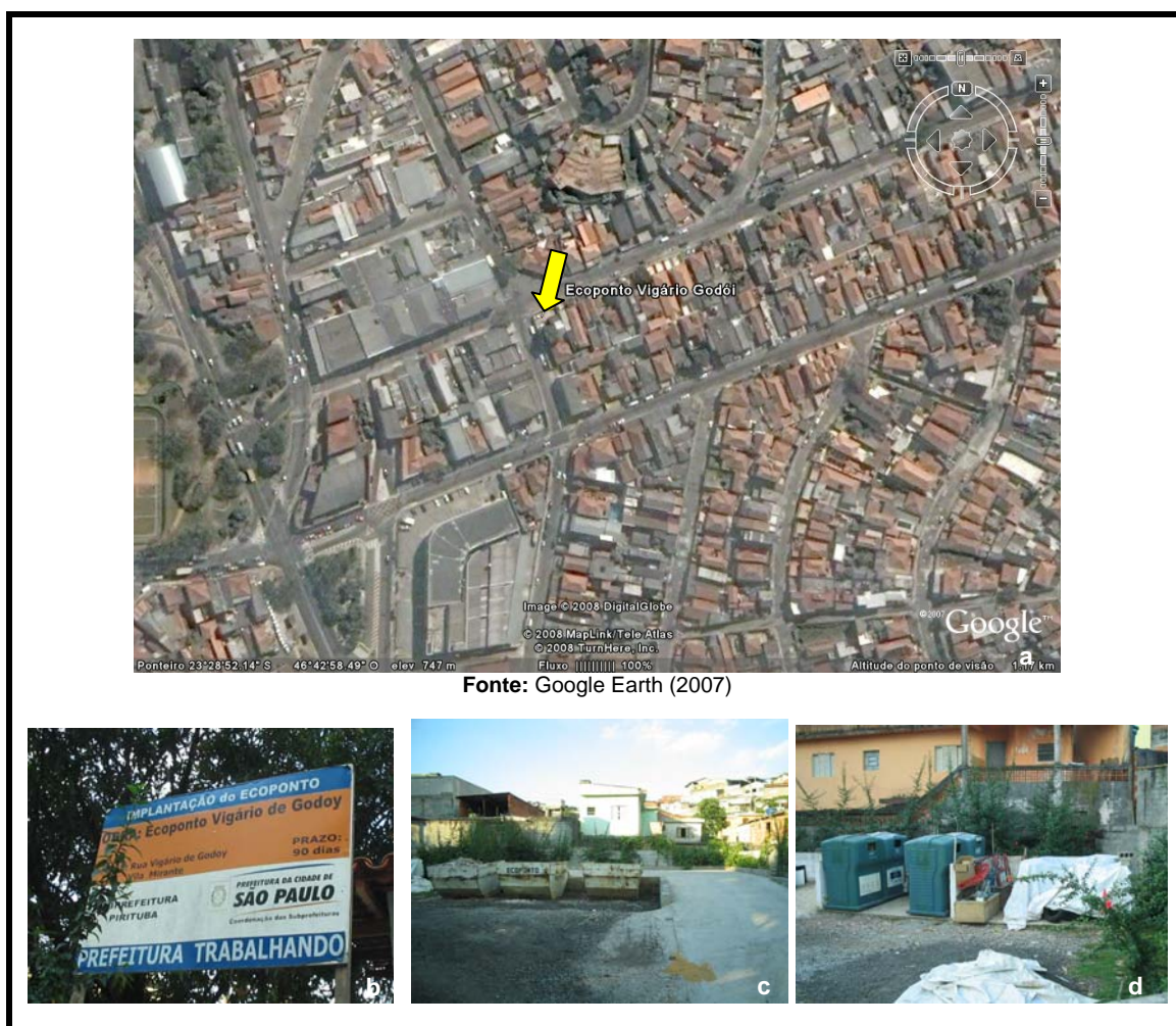
Figura 28 – Ecoponto Vigário Godoi: a) foto aérea da localização; b) placa de implantação; c) caçambas para recebimento de entulho; d) contêineires para recebimento de recicláveis
