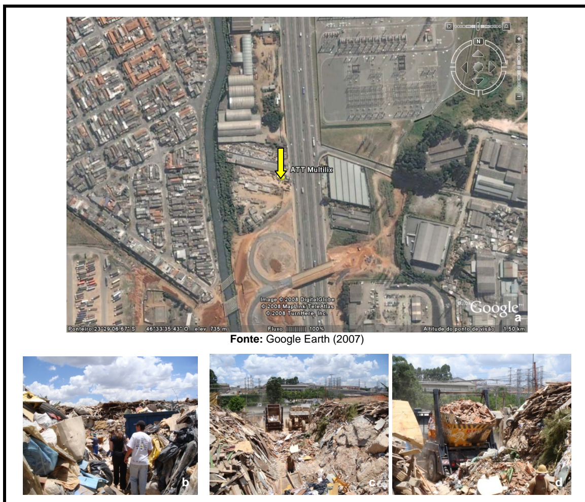
Figura 12 – ATT Multilix: a) foto aérea da localização; b) entrada da unidade; c) entulho a espera para ser triado; d) recebimento de uma caçamba de entulho
