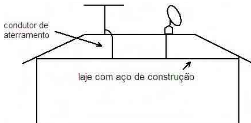
Anexo Figura 1 – Aterramento das antenas
