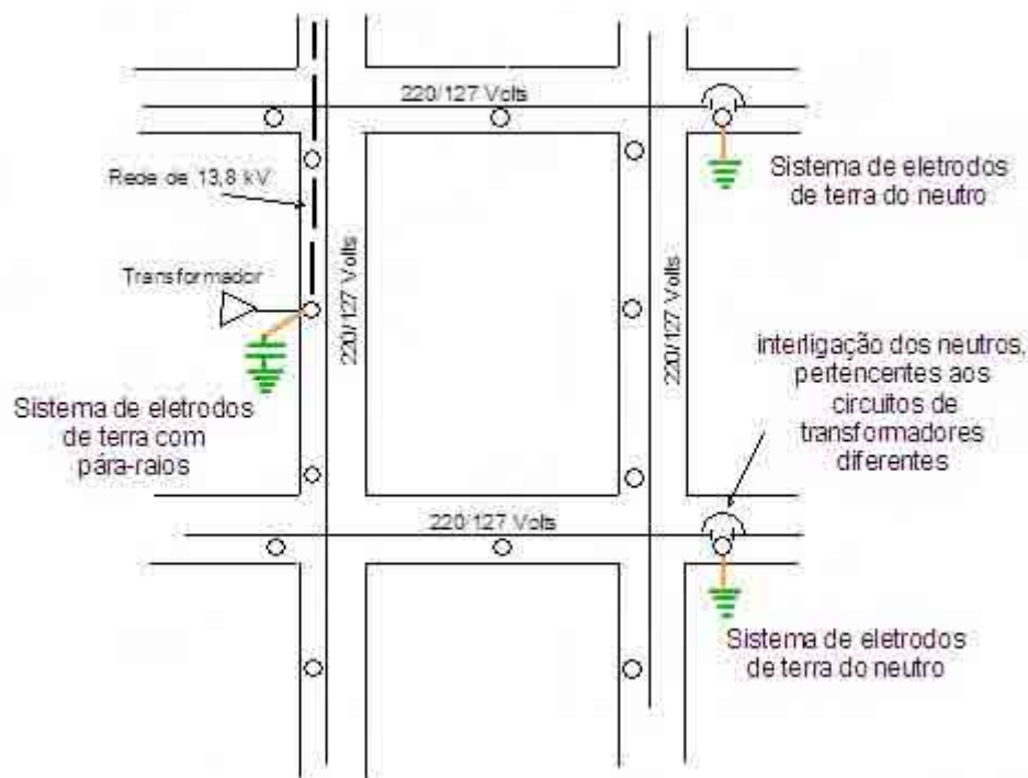
Figura 5.4 – Rede de distribuição urbana com neutro multiaterrado
