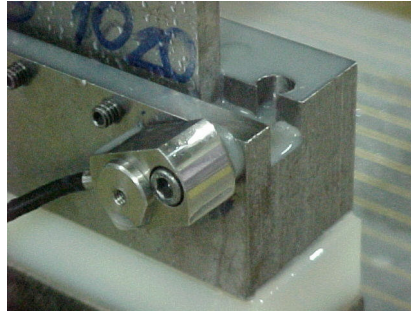
Figura 24 – Fixação do sensor de emissão acústica
