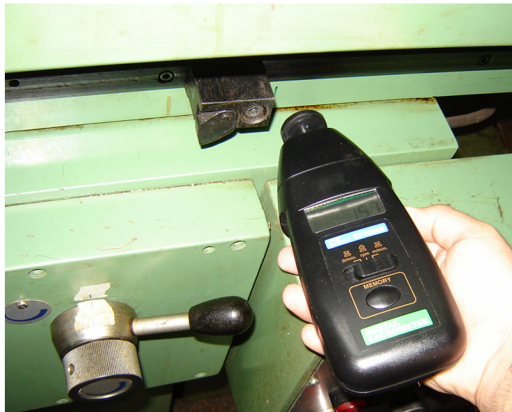
Figura 20 – Ajuste da velocidade tangencial da mesa com tacômetro ( V_w )
