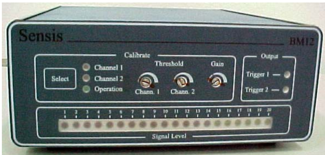
Figura 28 – Módulo de Emissão Acústica
