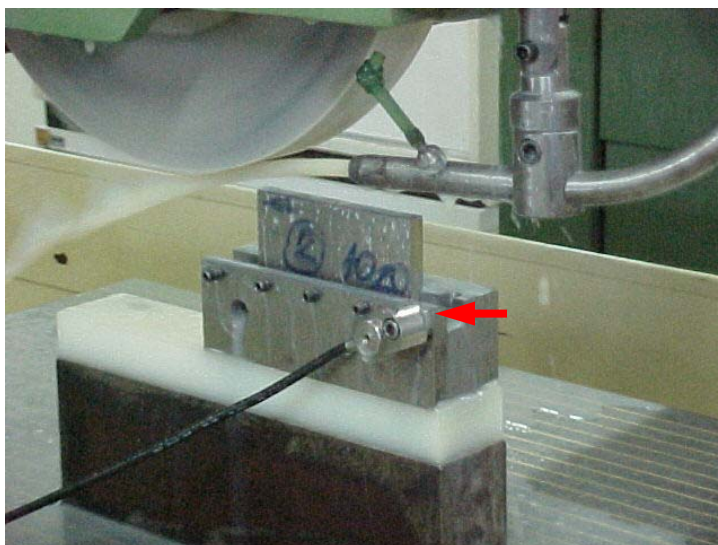
Figura 29 – Posicionamento do Sensor Piezo-Elétrico
