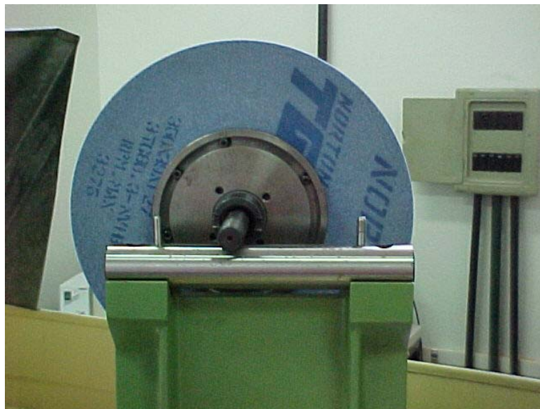
Figura 31 – Suporte utilizado no balanceamento do rebolo
