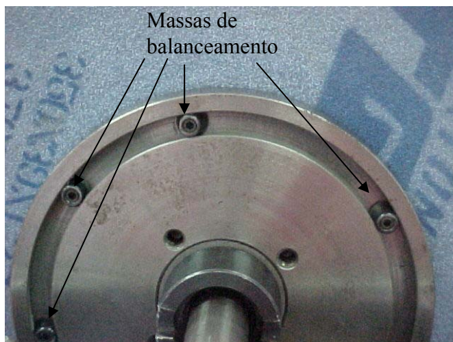
Figura 32 – Massas de metal utilizadas para balancear o rebolo
