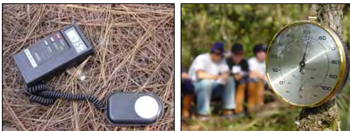
Figura 7 - Da esquerda para a direita, luxímetro, utilizado para medidas de luminosidade, e termohigrômetro, equipamento que fornece informações de temperatura e umidade.
