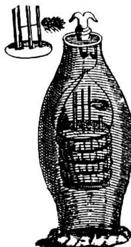
Figura 23: Montagem realizada por Boyle, usada na tentativa de encontrar um meio mais sutil que o ar.
