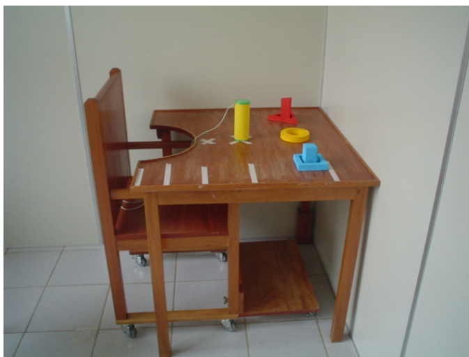
Figura 3 – Mobiliário adaptado com opções de regulagem para altura da mesa e apoio para os pés, o transdutor de força e o recurso pedagógico utilizados no estudo.
