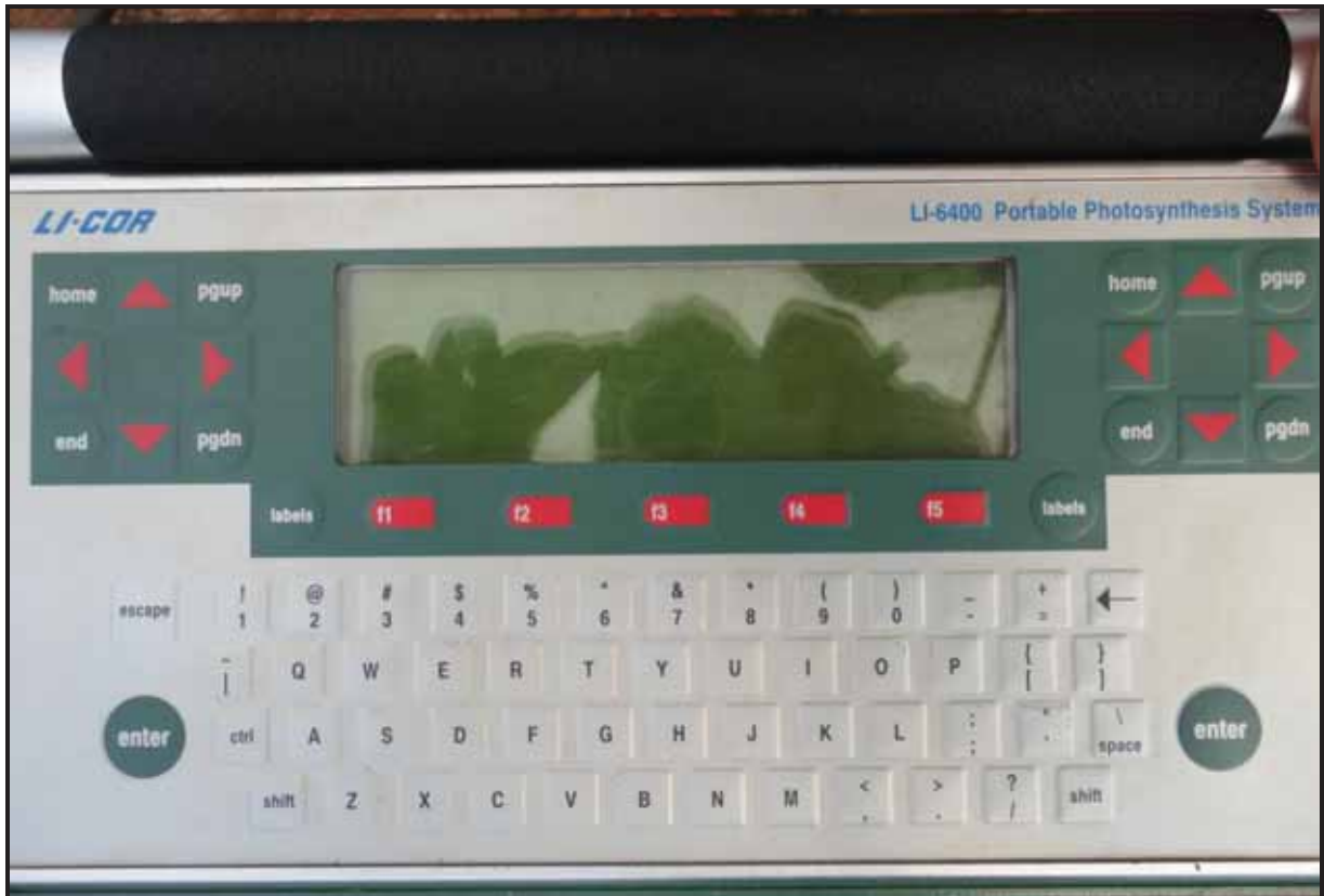
Figura 4. Aparelho LI – 6400 (Portable Photosynthesis System) da empresa LI-COR® empregado para medição da taxa fotossintética.
