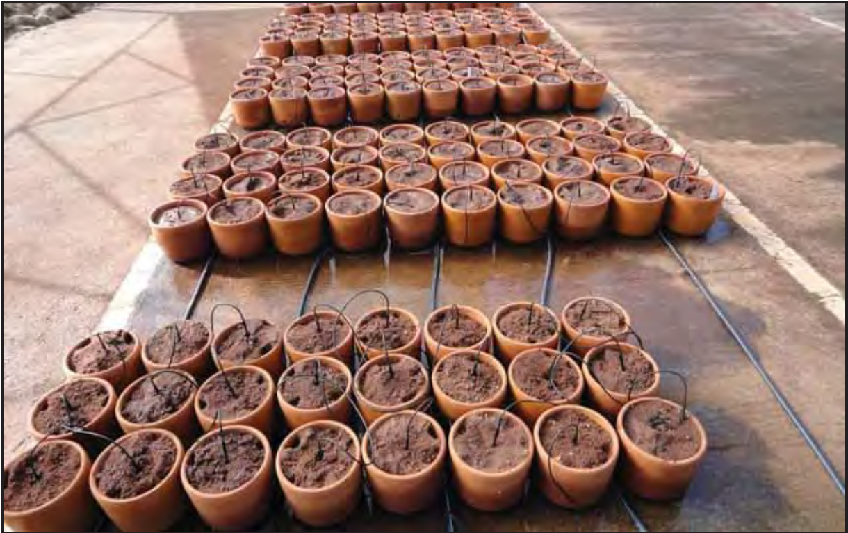
Figura 5. Esquema geral do experimento realizado em vasos com 6L de capacidade contendo como substrato uma mistura de areia e terra (2:1), previamente autoclavada e o sistema semi-automático de gotejo.
