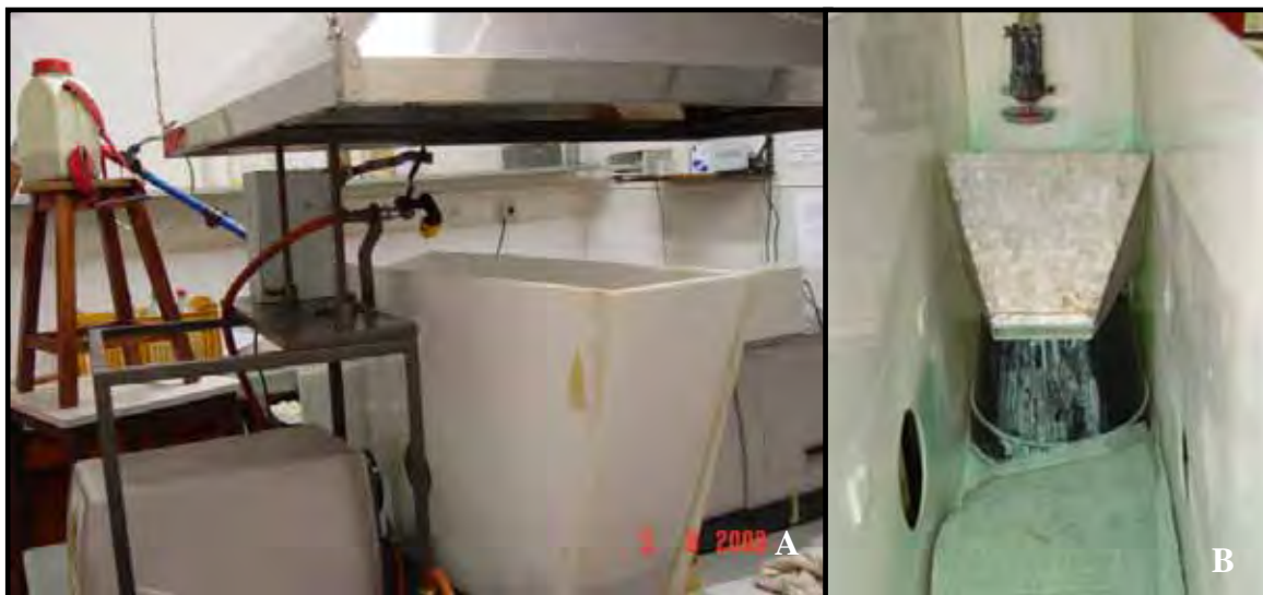
Figura 4. A) Aparelho medidor de tamanho de partículas em tempo real B) proteção da lente para leitura das gotas produzidas pelo bico rotativo.
