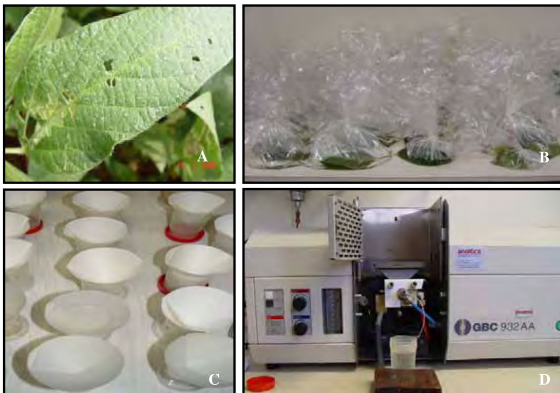
Figura 3. A) Folha com cobre na superfície após aplicação no campo, B) Extração do cobre, C) Filtragem e D) Leitura do extrato em espectrofotômetro de absorção atômica.
