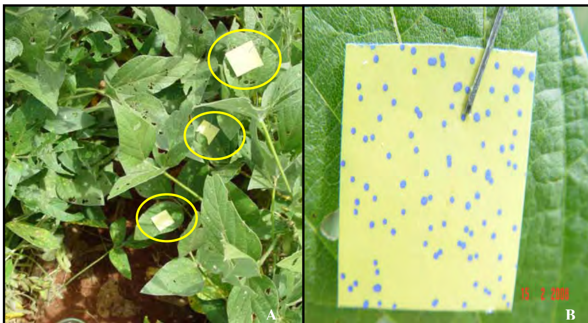
Figura 2. A) Papéis hidrossensíveis, posicionado em três posições da planta, representando em altura o terço inferior, médio e superior. B) Papel preso à planta através de grampo metálico
