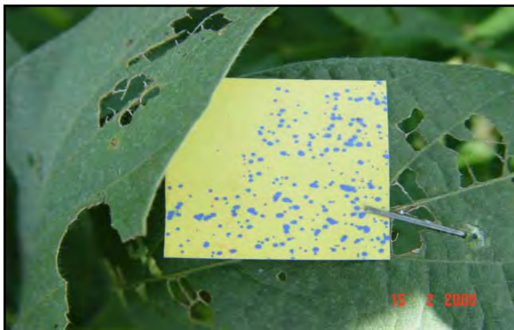
FIGURA 8. Efeito “guarda-chuva” proporcionado pelas folhas localizadas acima do papel hidrossensível.
