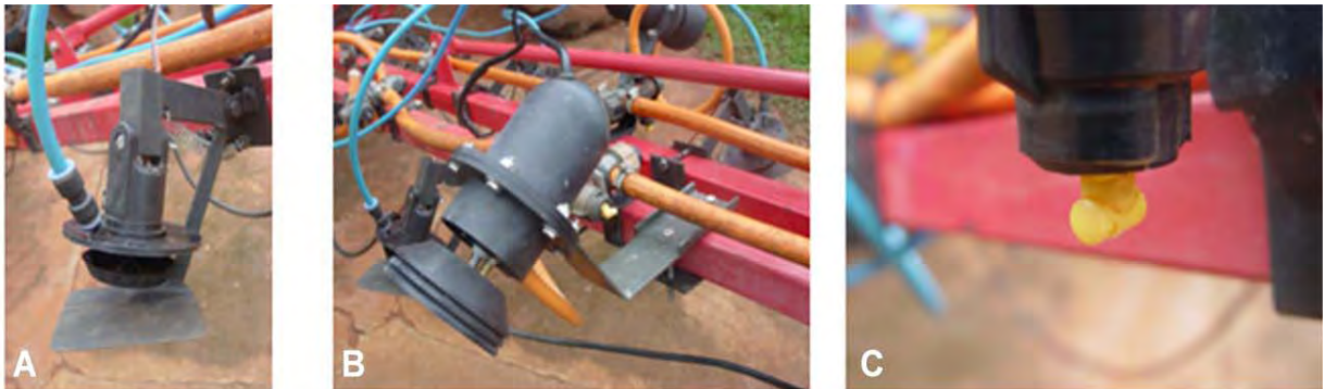
Figura 2. (A) Bico centrífugo Ecos; (B) Bico centrífugo Turbotrator; (C) Bico Hidráulico TT11002 utilizados para avaliação da cobertura, deposição, tamanho de gotas, controle do bicudo-do-algodoeiro e produtividade do algodão
