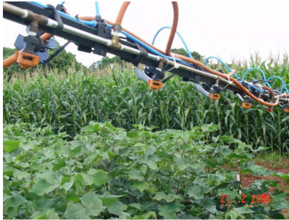
Figura 3. Barra úmida anexada à barra de pulverização para suporte dos bicos de energia hidráulica
