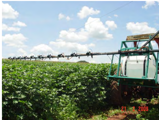
Figura 1. Pulverizador utilizado no experimento para avaliação de cobertura de gotas e deposição de inseticida na cultura do algodão.
