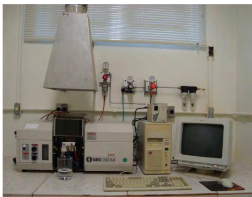
Figura 6. Espectrofotômetro GBC 932 AA utilizado para leitura do marcador manganês.
