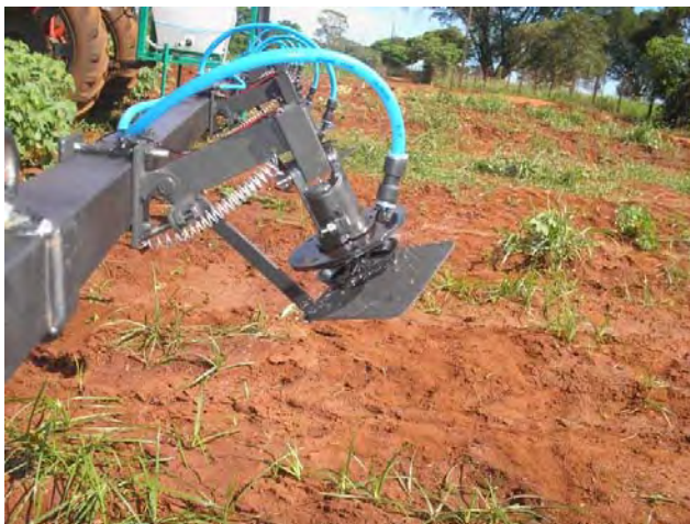
Figura 2. Bico rotativo Ecos da Apiootec para avaliação de cobertura pelas gotas e deposição de inseticida na cultura do algodão.
