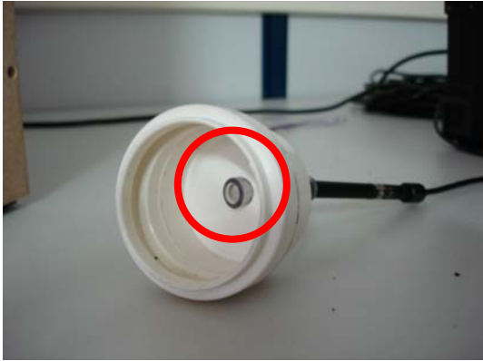
Figura 8 – Canal auditivo simulador (visão interna)
