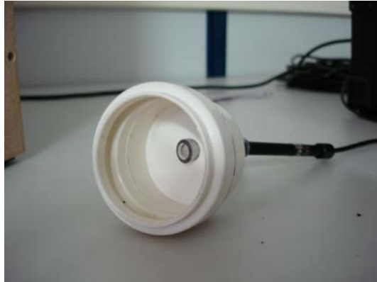
Figura 2 – Canal auditivo simulador (visão interna)
