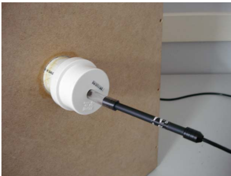
Figura 1 – Microfone acoplado ao conduto auditivo simulador humano
