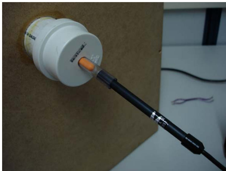
Figura 7 – Detalhe do EPIa instalado dentro do canal auditivo simulador e acoplado ao microfone.
