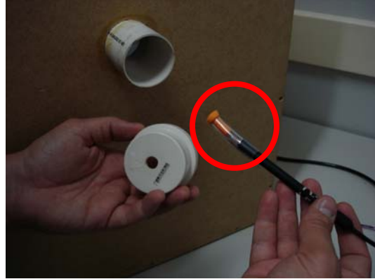
Figura 9 – Canal auditivo simulador (visão externa com EPIa introduzido)
