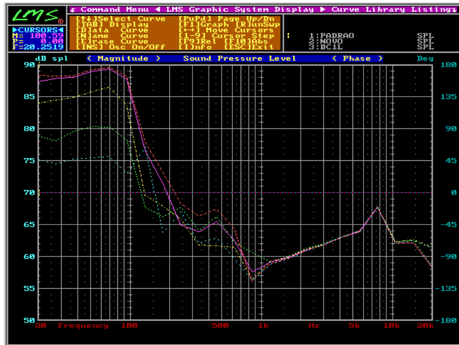
Figura 17 - Visualização de curvas com EPlas de 10( verde), 12(azul), 14(amarelo), 16(rosa) e 18(vermelho) dias de uso.
