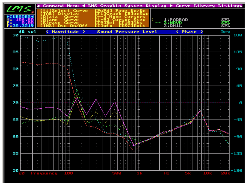
Figura 23 – Visualização de curvas com EPLa novo(verde) e EPLas com 2(amarelo), 4(rosa), 6(vermelho) e 8(azul) dias de uso.
