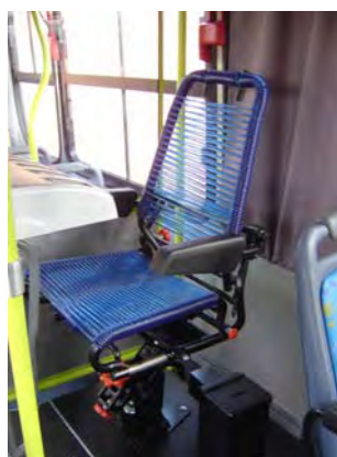
FIGURA 14 – Poltrona de motorista e cobrador de ônibus urbano, modelo “espaguete”, comum no norte do país em regiões quentes 7 .
