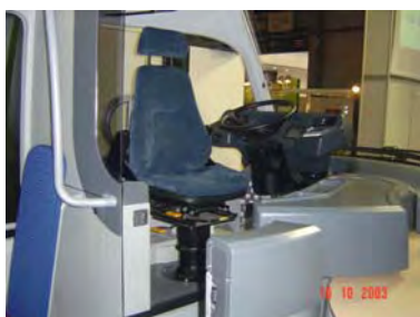
FIGURAS 15 e 16 – Posto de motorista de ônibus urbano europeu com modelo de poltrona giratória, encosto de cabeça, regulagens elétricas e ajustes diversos 8 .
