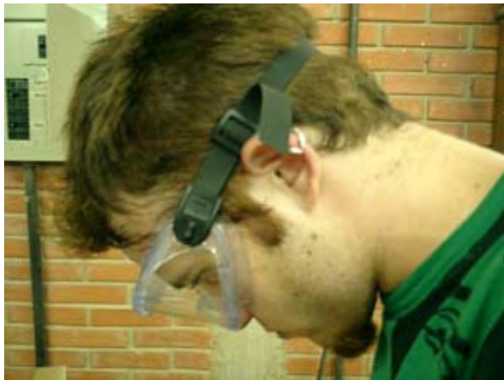
Figura 53 – Detalhe do elástico de fixação (modelo B)
