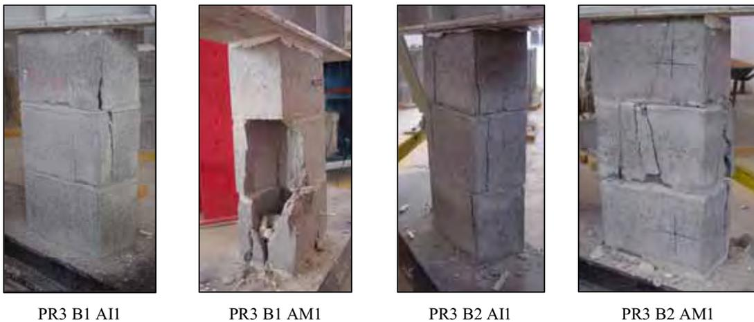
**Figura 4.9 – Forma rompida dos PR3.**
