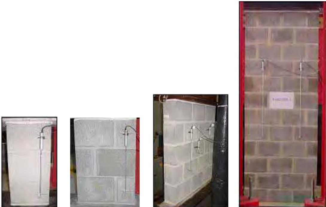
**Figura 3.2 – Posicionamento dos LVDT's.**
