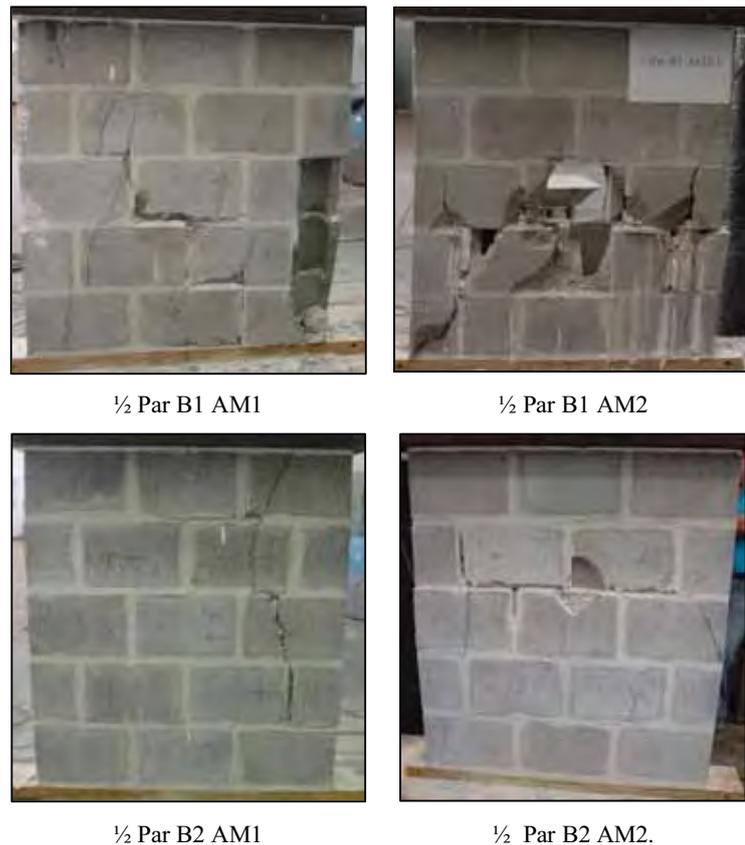
**Figura 4.17 – Forma rompida das  $\frac{1}{2}$  Par.**
