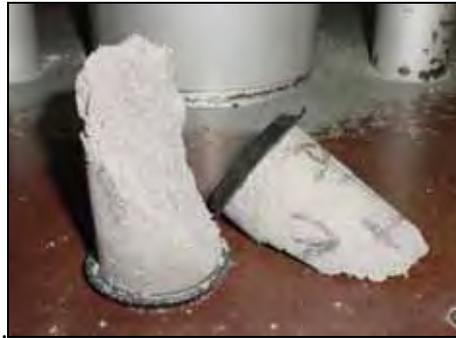
Figura 3.8 – Modo de ruptura dos corpos-de-prova de argamassa.
