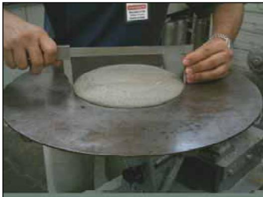
**Figura 3.10 – Medição de abertura da base do cone no ensaio de consistência.**
