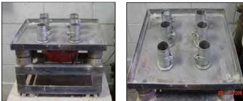
Figura 3.5 – Mesa vibratória utilizada na moldagem das argamassas industrializadas.
