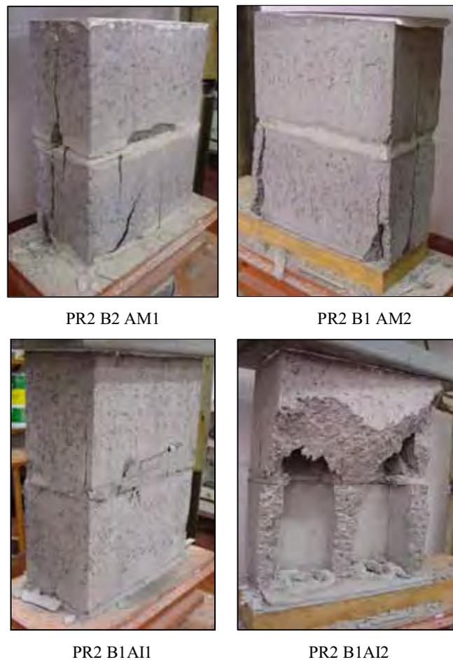
**Figura 4.6 – Forma rompida dos PR2.**
