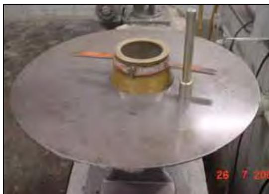
Figura 3.9 – Materiais para o ensaio de Índice de consistência.
