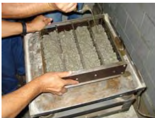
Moldagem dos prismas em duas camadas
