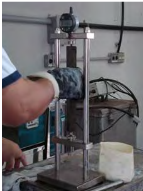
Figura 58 – Leituras das barras de argamassas
