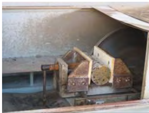
Figura 39 – Corte dos testemunhos em serra de disco
