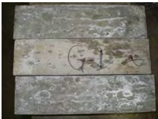
Agregado UHE Jaguari – Enrocamento Ensaio a 60° C
