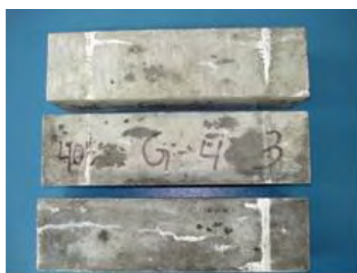
Agregado da pedra Sta. Isabel Ensaio a 40° C
