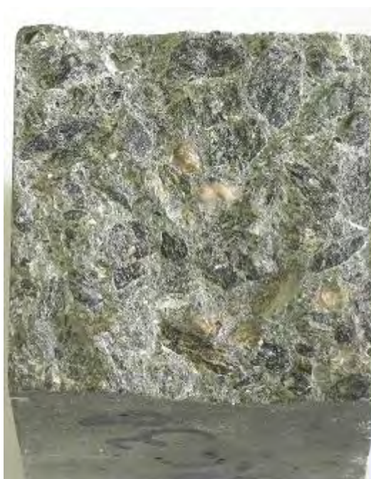
Figura 85 – Aspecto geral do concreto no qual se observa a argamassa cinza, as dimensões variadas do agregado graúdo, a porosidade normal e boa qualidade da amostra (amostra: ERC – 38)
