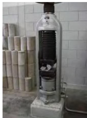
Figura 51 – Ruptura do CP posicionado com sua geratriz em contato com os pratos da prensa
