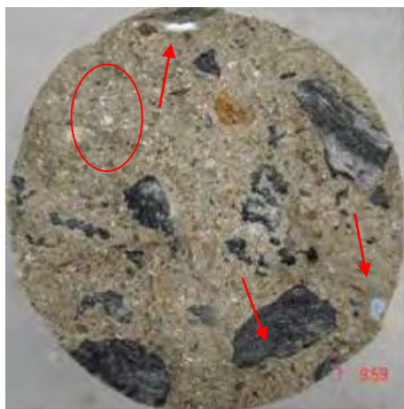
Poros brancos e bordas de reação – Laje da TA
