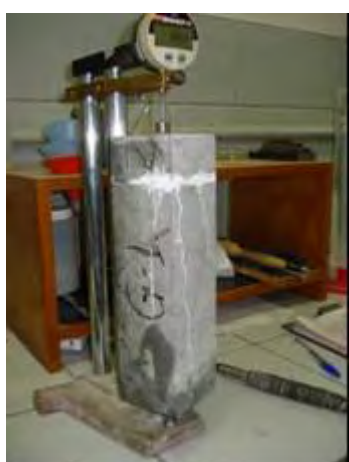
Agregado UHE Jaguari – Enrocamento Ensaio a 40° C
