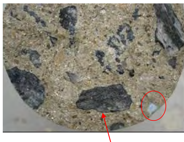
Bordas de reação (seta), poro com deposição de material branco com aspecto porcelânico (círculo) – Pilar da ponte da TA
