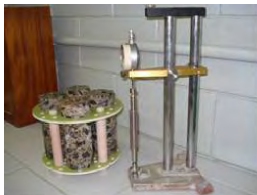
Figura 45 – Suporte e base de leituras adaptados para realização do ensaio de reatividade
