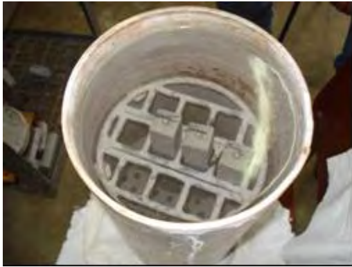
Figura 56 – Barras imersas em água a 80°C por 24 horas
