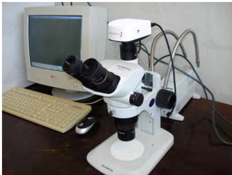
Figura 68 – Microscópio estereoscópico de luz refletida utilizado na análise
