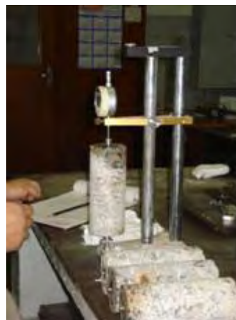
Figura 47 – Leitura das expansões no relógio comparador
