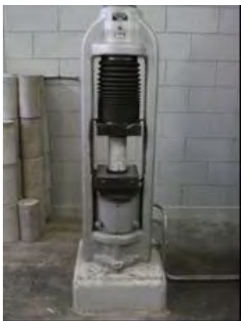
Figura 48 – Ensaio de resistência à compressão
