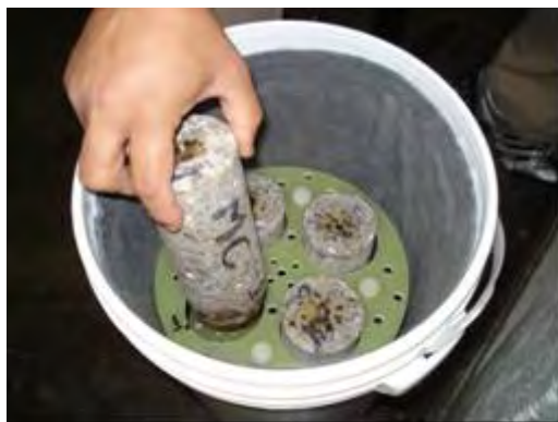
Figura 46 – Armazenamento dos CPs nos baldes preparados para o ensaio
