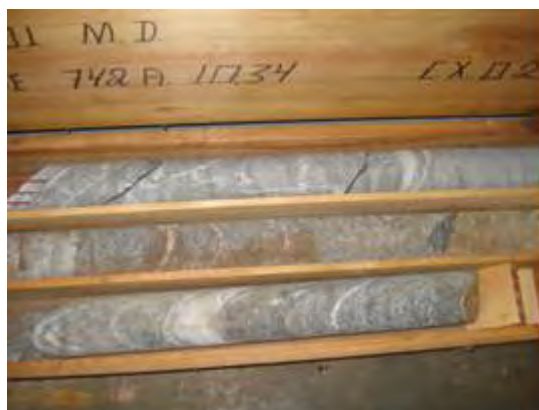
Figura 33 – Testemunhos de sondagem da rocha de fundação da TA da UHE Jaguari
