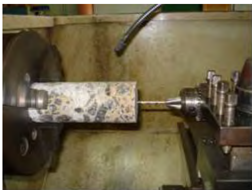
Figura 42 – Perfuração dos testemunhos no torno para fixação dos pinos
