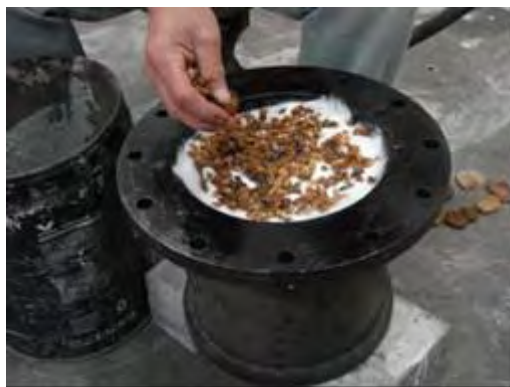
Etapa final da montagem do ensaio – no topo, uma camada de algodão, cascalho e brita
