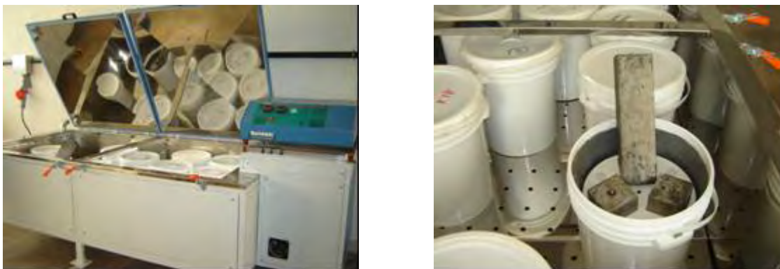
Figura 63 – Câmara térmica (40° e 60°C) para acondicionamento dos prismas de concreto
