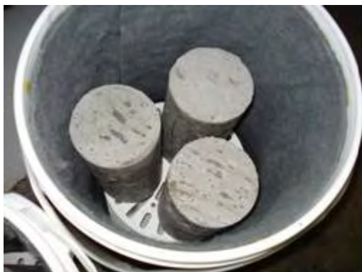
Figura 52 – Corpos de prova armazenados nos mesmos recipientes do ensaio NBR 15577-6
