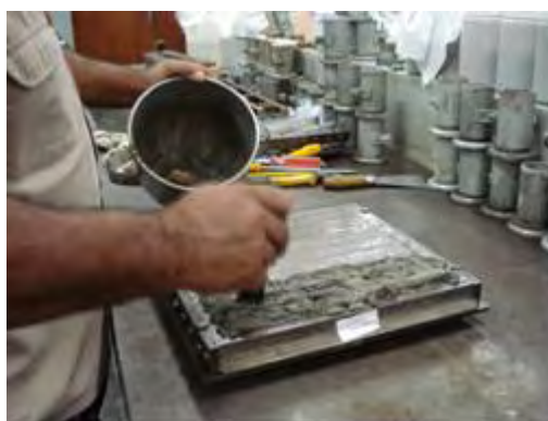
Figura 55 – Confeção das barras de argamassas para ensaio de reatividade
