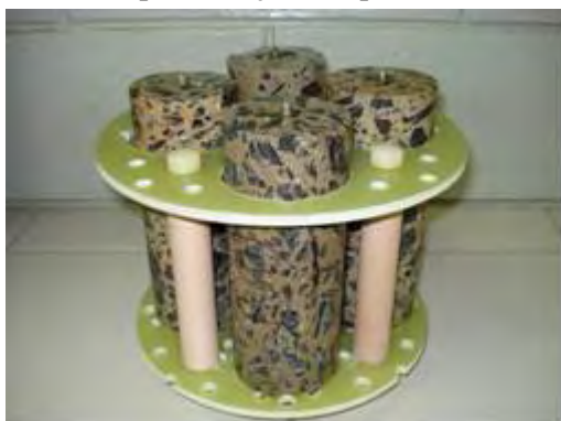
Figura 44 – Testemunhos nos suportes do ensaio de reatividade
