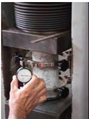
Figura 50 – CPs preparados para o ensaio de resistência à tração por compressão diametral
