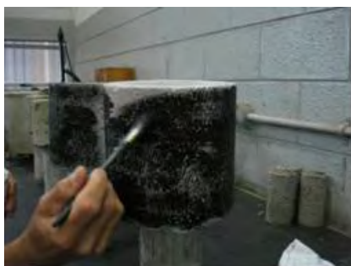
Laterais escarificadas com jato de areia – preparação com duas demãos de neutrol
