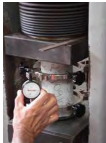
Figura 49 – Ensaio de módulo de elasticidade
