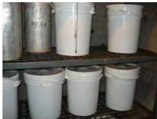
Figura 53 – Armazenamento dos CPs em câmara a 40°C
