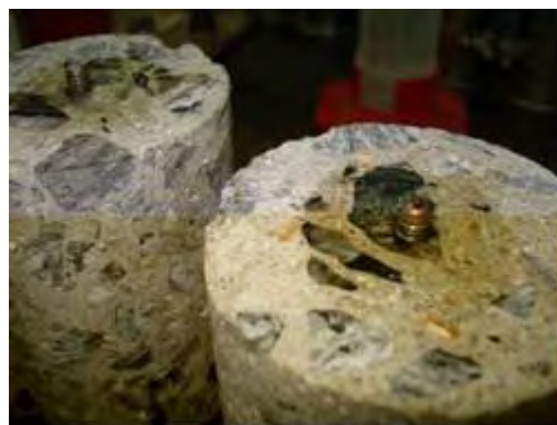
Figura 43 – Pinos colados com adesivo epóxi nas duas extremidades dos testemunhos
