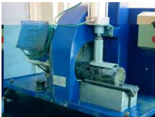
Figura 40 – Retificação das superfícies dos testemunhos
