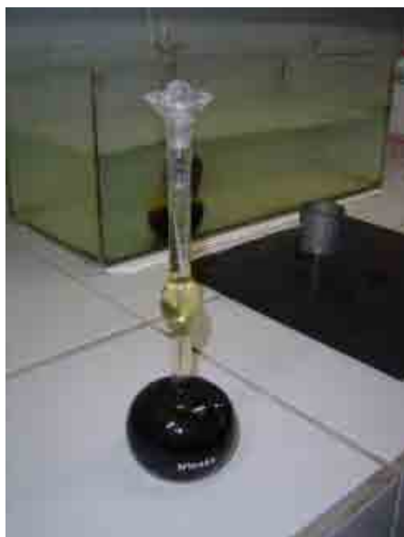
Figura 26: Frasco Chapman com querosene e resíduos de borracha de pneu
