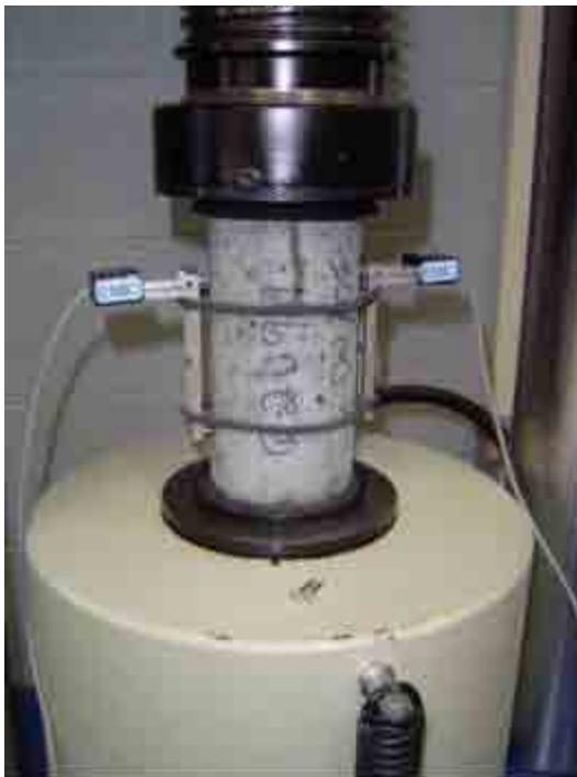
Figura 49: Par de LVDT fixados no corpo-de-prova
