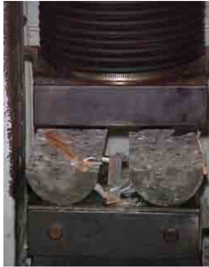
Figura 75: Corpo-de-prova de CAD após o ensaio de tração
