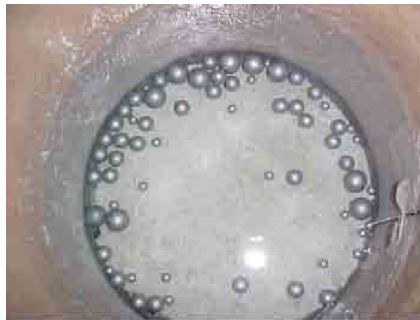
Figura 57: Corpo-de-prova submerso no interior do aparelho de abrasão e esferas de aço
