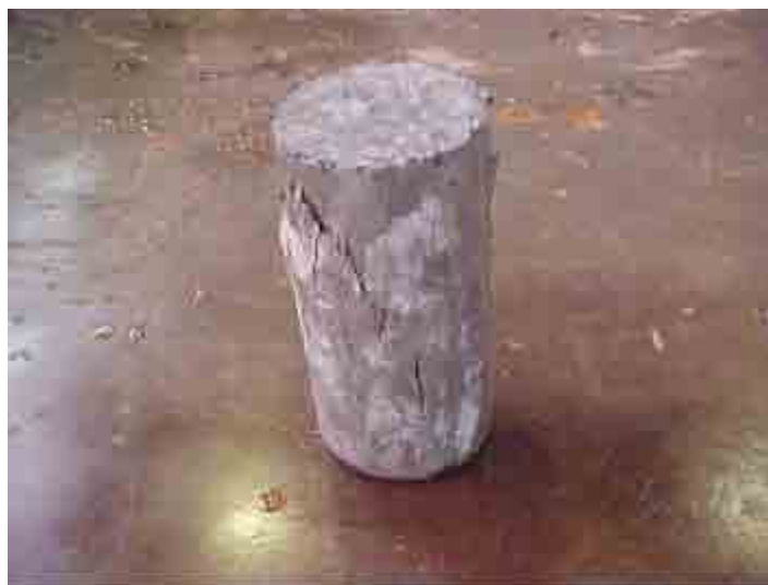
Figura 61: Típico corpo-de-prova dos traços com adição de borracha rompido à compressão (7dias)
