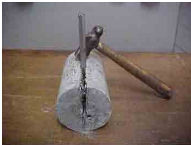
Figura 77: Detalhe do procedimento de abertura do corpo-de-prova de CAD com Borracha
