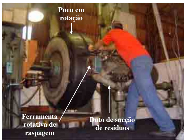
Figura 10: Operação de raspagem do pneu à ser recauchutado
