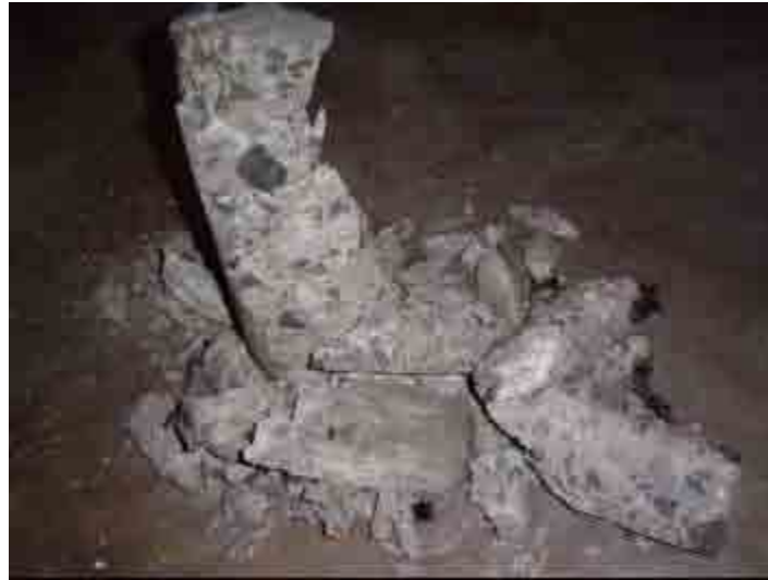
Figura 66: Corpo-de-prova de CAD rompido à compressão (7 dias)
