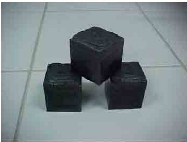
Figura 52: Corpos-de-prova de composto de enxofre de alta resistência
