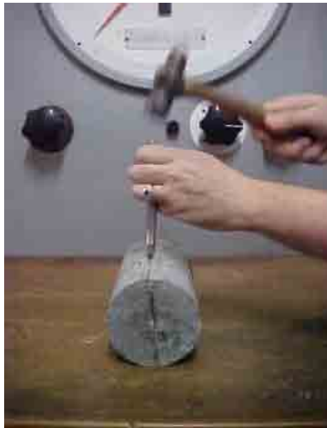
Figura 76: Corpo-de-prova de CAD com Borracha após o ensaio de tração
