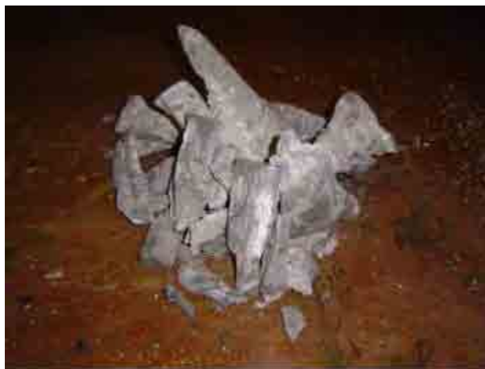
Figura 70: Corpo-de-prova de CAD rompido à compressão (91 dias)
