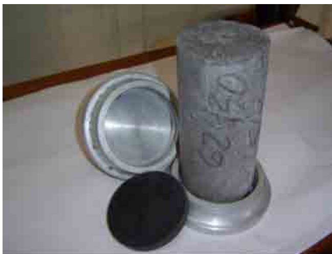
Figura 3: Sistema de capeamento não aderente constituído por bases de neoprene e anéis de alumínio
