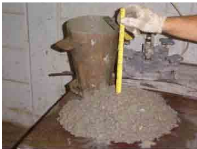
Figura 43: Ensaio de Abatimento do tronco de cone
