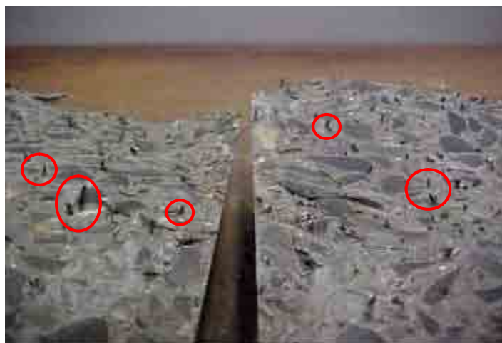
Figura 78: Corpo-de-prova de CAD com Borracha após abertura
