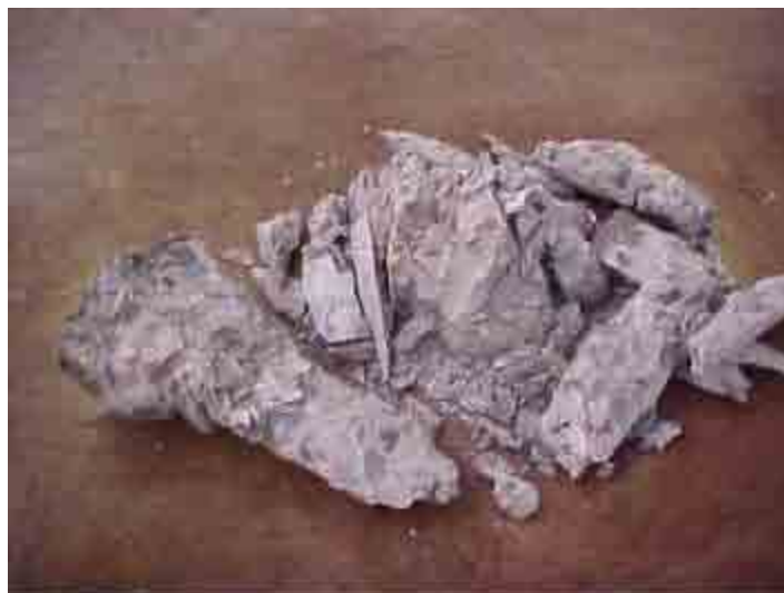
Figura 60: Típico corpo-de-prova do traço padrão rompido à compressão (7dias)
