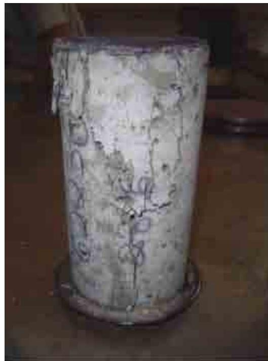
Figura 69: Corpo-de-prova de CAD com Borracha rompido à compressão (28 dias)
