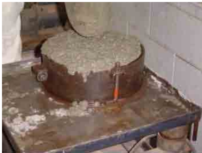
Figura 40: Moldagem do corpo-de-prova para ensaio de resistência à abrasão
