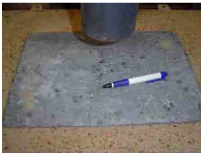
Figura 83: Última fissura observada (0,5mm) em uma das placas de CAD com Borracha
