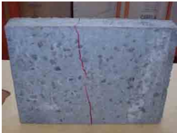
Figura 84: Placa de CAD com Borracha ao fim do ensaio, face superior
