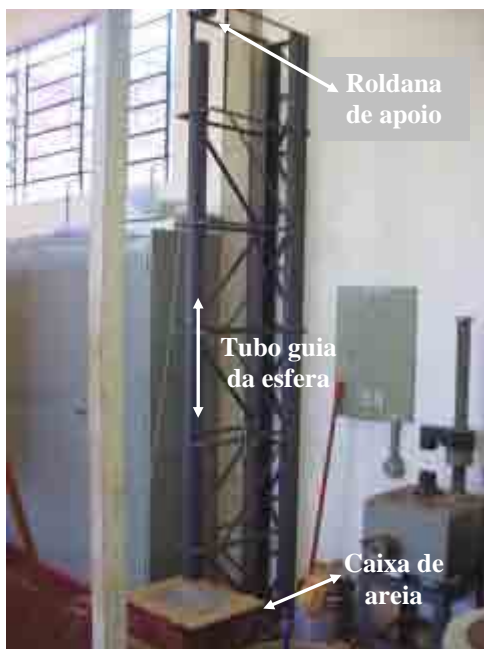
Figura 53: Aparato para ensaio de resistência ao impacto
