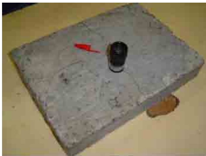
Figura 85: Placa de CAD com Borracha ao fim do ensaio, face inferior
