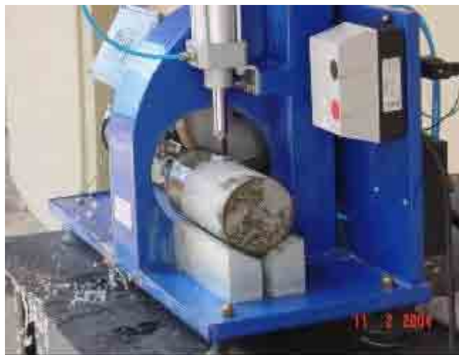
Figura 6: Máquina retificadora de corpos-de-prova de concreto Fonte: MARTINS et al. (2004)
