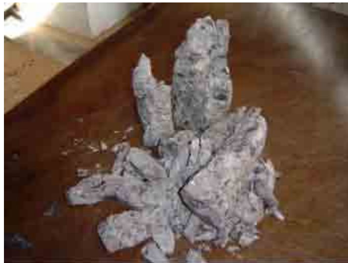
Figura 68: Corpo-de-prova de CAD rompido à compressão (28 dias)
