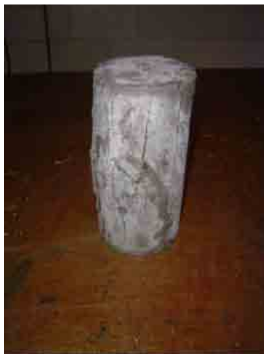
Figura 71: Corpo-de-prova de CAD com Borracha rompido à compressão (91 dias)
