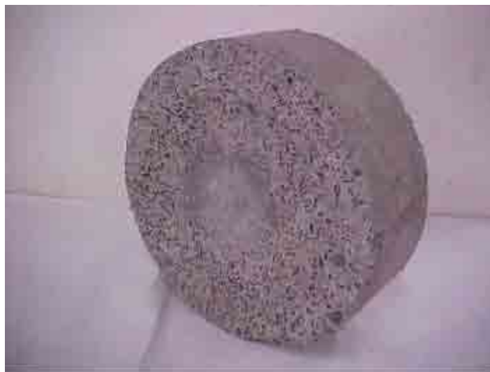
Figura 90: Corpo-de-prova de CAD com Borracha ao fim das 71 horas de ensaio de abrasão
