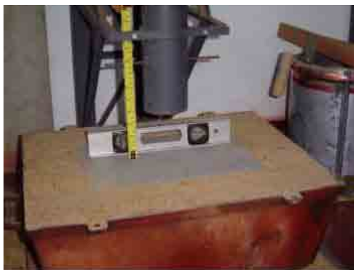
Figura 54: Detalhe do ajuste do corpo-de-prova
