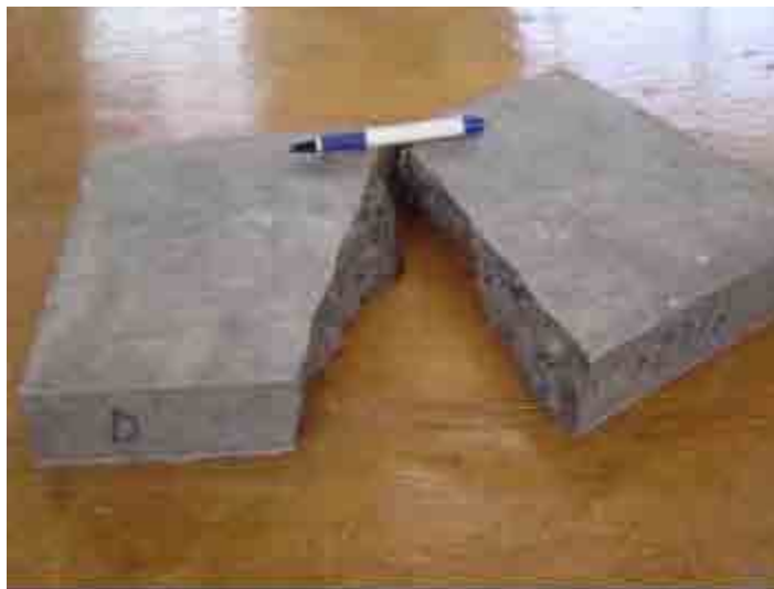
Figura 82: Placa de CAD ao fim do ensaio
