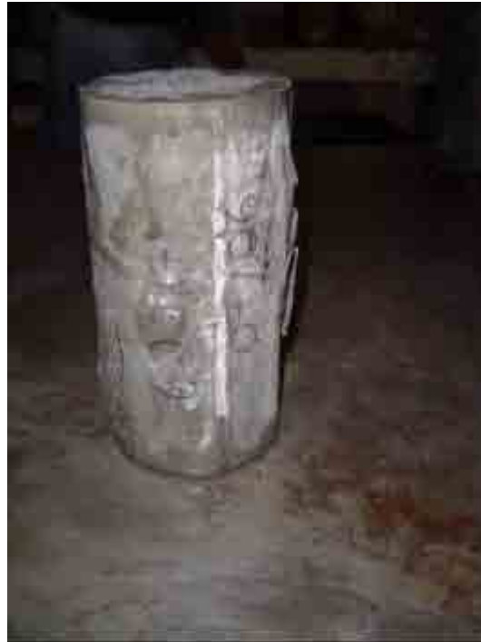
Figura 67: Corpo-de-prova de CAD com Borracha rompido à compressão (7 dias)
