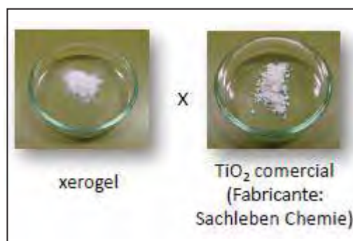
Figura I.1 - Foto do xerogel obtido através do processo sol-gel e do TiO_2 de uso comercial.
