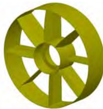
Figura 4.4 – Desenho 3D das aletas direcionadoras de fluxo
