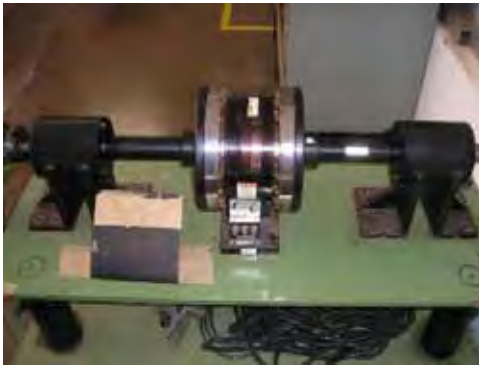
Figura 5.8 – Célula de carga (CG)
