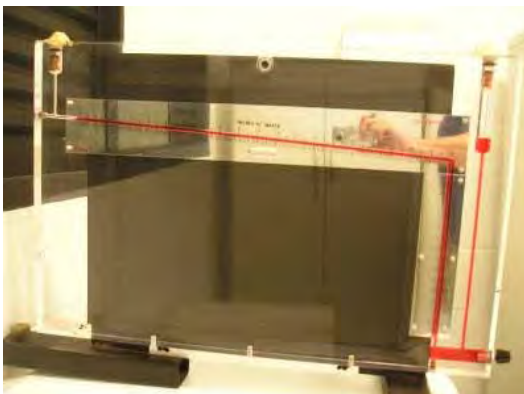
Figura 5.10 – Coluna d água inclinada
