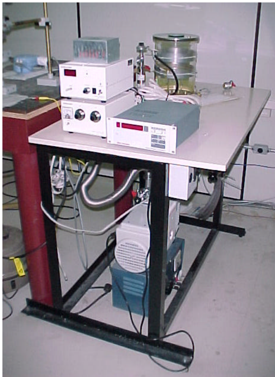
Figura 3.1 – Fotografia do sistema de deposição polimérica utilizado na confecção dos filmes.
