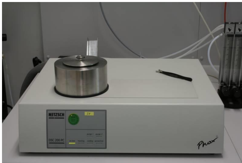
Figura 4.9 – Equipamento de DSC (Calorimetria Diferencial Exploratória)
