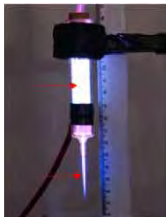
Figura 20: Pluma de plasma de hélio para uma tensão de 10 kV e um fluxo de 4 l/min. As setas indicam as regiões analisadas.
