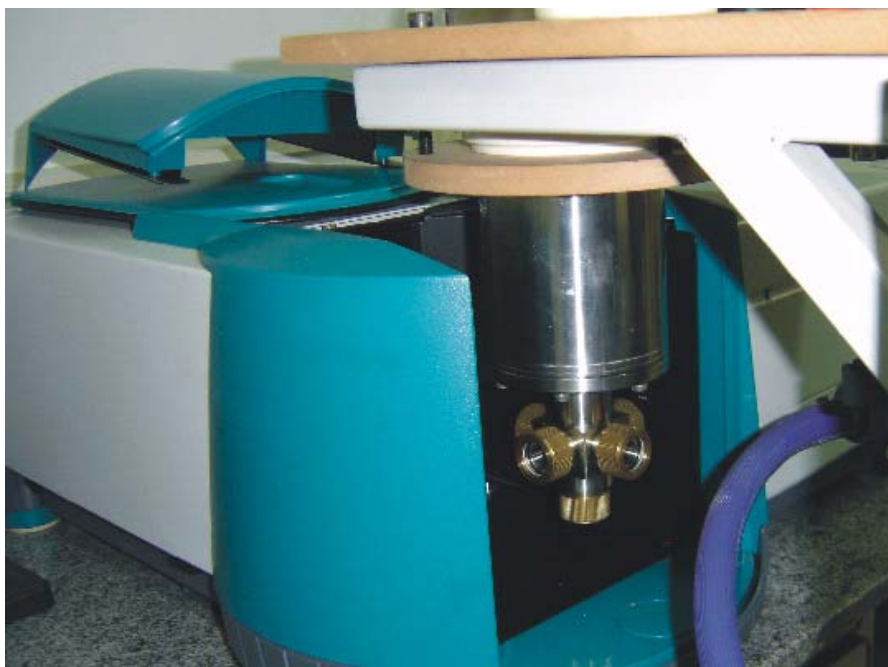
Figura 3.13 Criostato sendo utilizado para medir o espectro de emissão de uma amostra a baixa temperatura.
