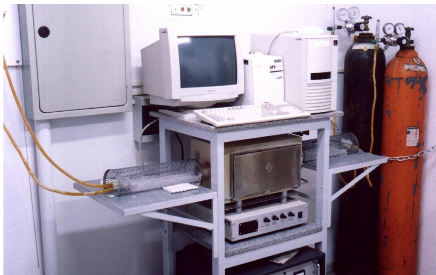
Figura 3.4 Forno com controlador de taxa de aquecimento e atmosfera controlada.
