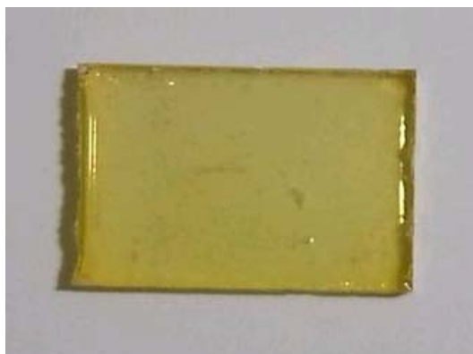
Figura 3.3 Xerogel dopado com PPV (com \text{MassaPPV/MassaSi}=9,95 \times 10^{-5} ) após secagem e envelhecimento.
