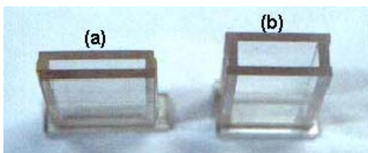
Figura 3.1 Moldes de policarbonato utilizados, para obtenção de amostras com espessuras de (a) 2 mm e (b) 4 mm.
