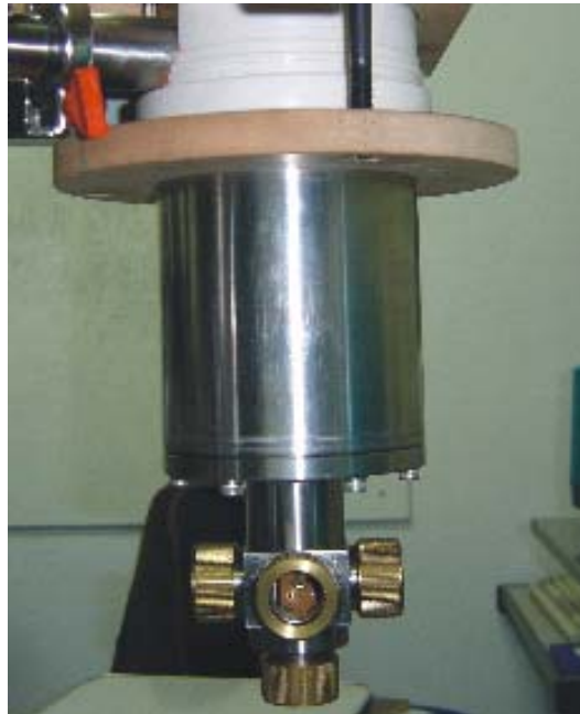
Figura 3.12 Foto do criostato resfriado com nitrogênio.
