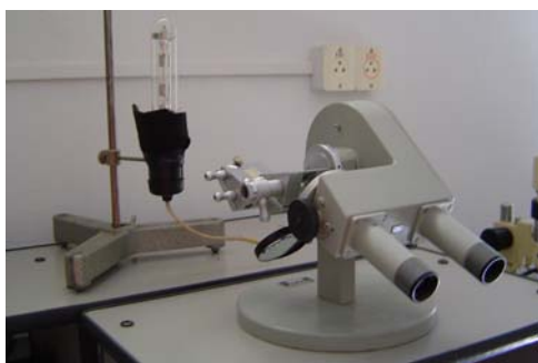
Figura 3.12. Refratômetro comercial tipo Abbe (Carl Zeiss/Jena).
