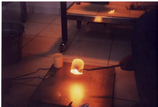
Figura 4.3. Um vidro prestes a ser vertido sobre chapa de aço inox.
