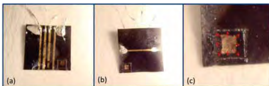
Figura 27: (a) e (b) Eletrodos depositados para a medida na direção transversal. (c) Detalhe do eletrodo contornado por feixe de laser. As setas indicam a corrente bloqueada pela barreira amorfa.
