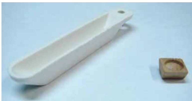
Figura 3: Navícula de alumina (esquerda) e cadinho usinado em pedra-sabão para a sinterização de pó pastilhado de BiMn 2 O 5 .
