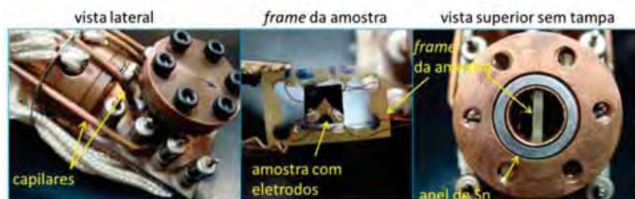
Figura 17: Detalhamento das principais partes do corpo da célula de pressão hidrostática.
