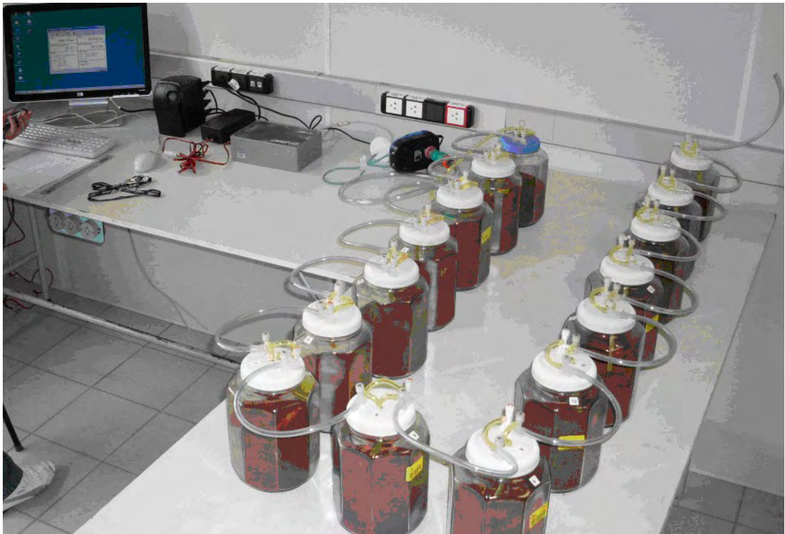
Figura 26 – Foto do esquema da unidade de medição de CO 2 liberado pelo solo, com o analisador de gases LI-COR 840
