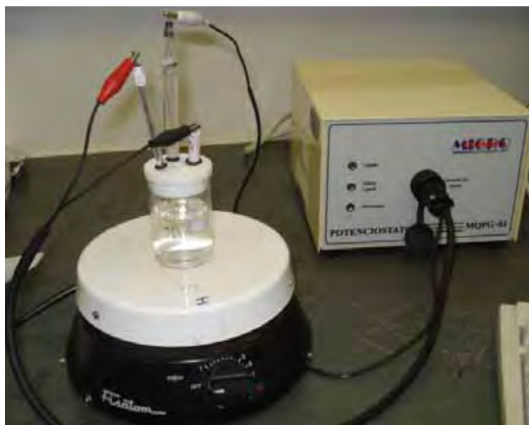
Figura 17: Sistema eletroquímico utilizado.
