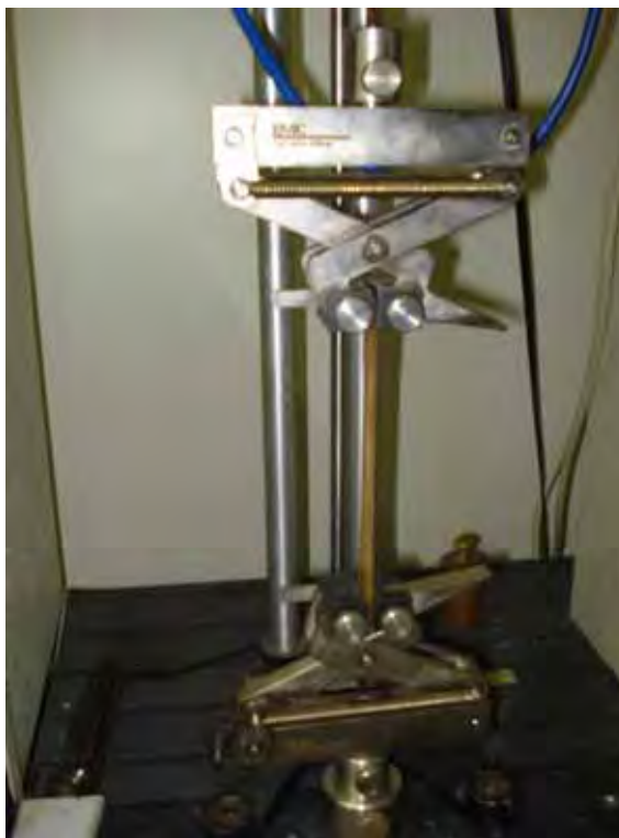
Figura 17: Máquina utilizada para o ensaio de tração (Emic DL 200).
