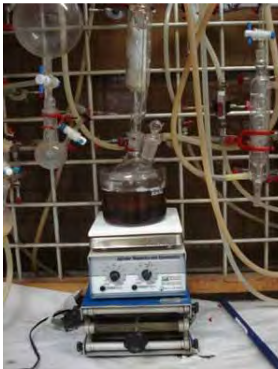
Figura 14: Esquema montado para o tratamento das fibras com água destilada.
