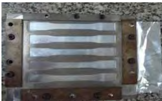
Figura 15: Molde utilizado para a preparação do corpo de prova para o ensaio de tração.
